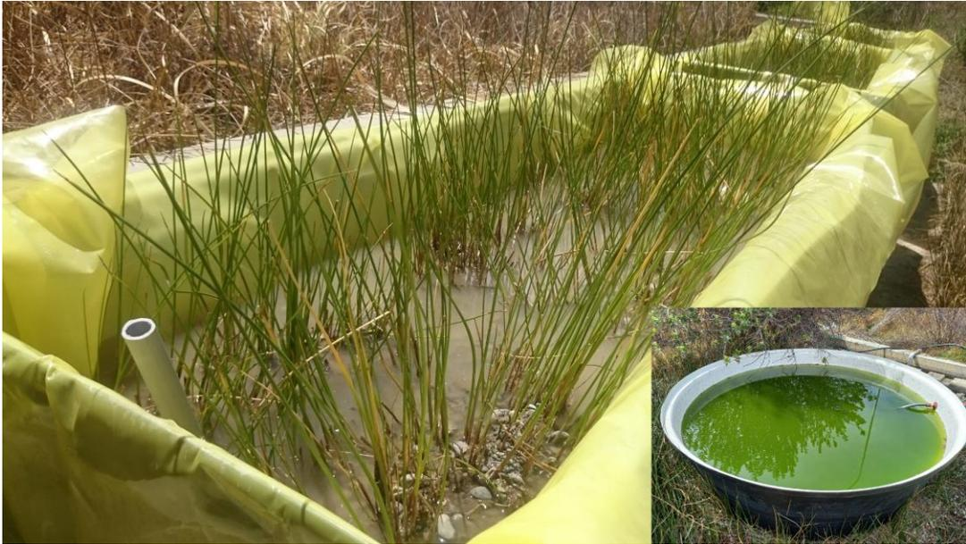
Figura S1. Ejemplo de un mesocosmos que conforma el sistema de fitorremediación con plantines de *S. californicus* en proceso de aclimatación. En la esquina inferior derecha se incluye una foto del tanque de suministro de nutrientes (M0).
