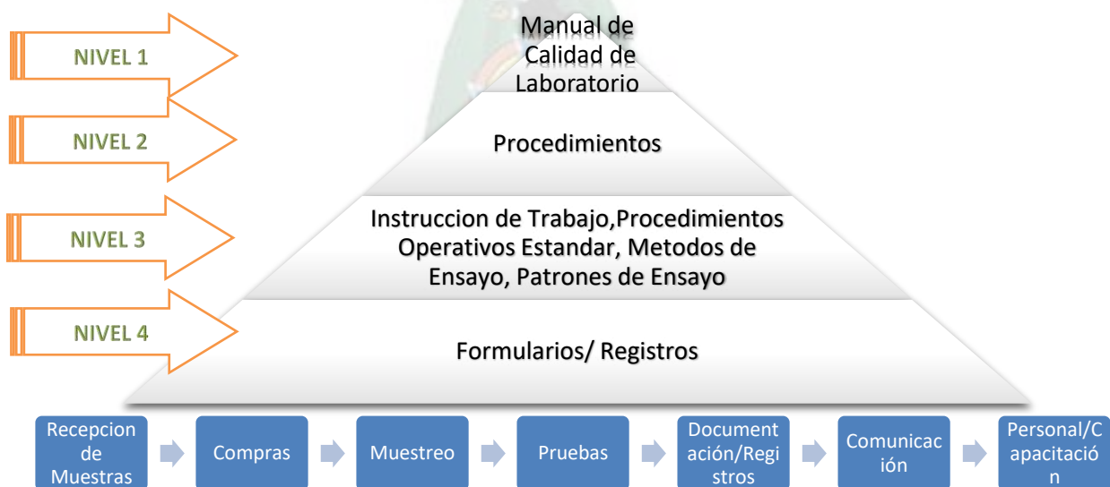
Figura 16: Estructura Documental del Sistema de gestión del Laboratorio de Control de Calidad
