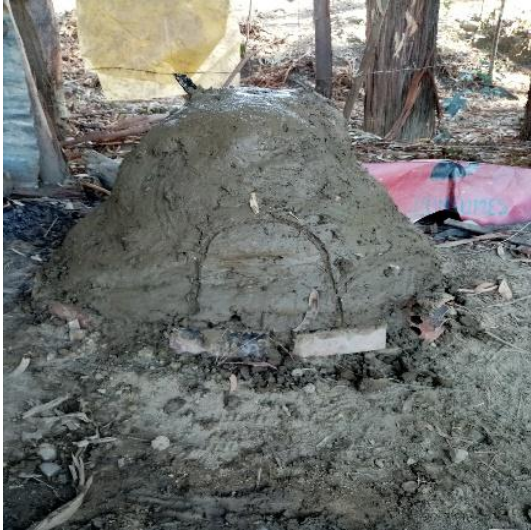
Fotografía 5. Horno artesanal, para el proceso de pirólisis
