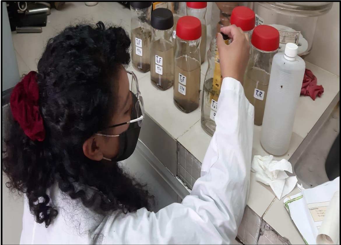
Foto 8. Medicion de parametros de pH, CE,STD
