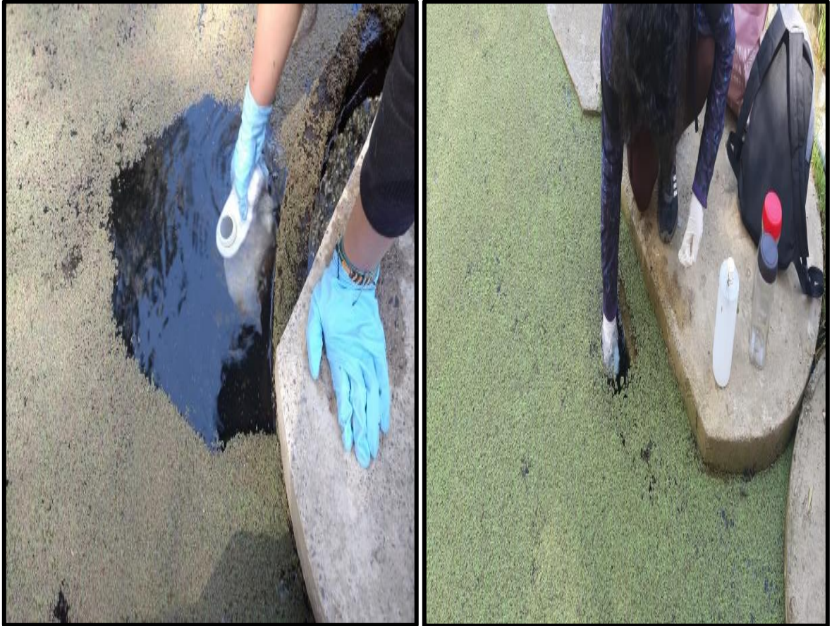
Foto 5. Toma de muestras de agua de la fuente de almacenamiento de agua de vertiente
