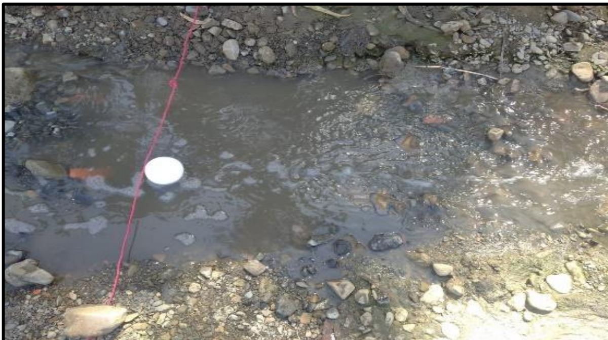
Foto 2. Medición del caudal del rio Jillusaya por el método del flotador
