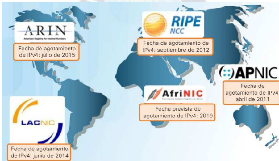
Figura 14: Fechas de Agotamiento de las direcciones IPv4 de RIR Fuente: CCNA 1 v6.0
