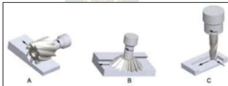
A) Fresado cilíndrico, (B) fresado frontal, (C) fresado de acabado
