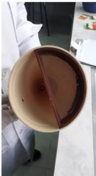
Verter el lodo por la malla del embudo
