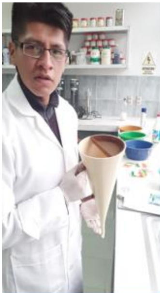
Verificar que el embudo no presente fugas
