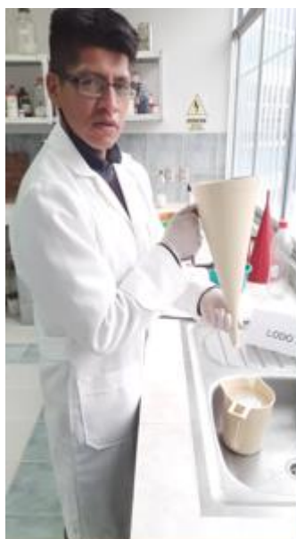
Levantarse el dedo del orificio y cronometrar
