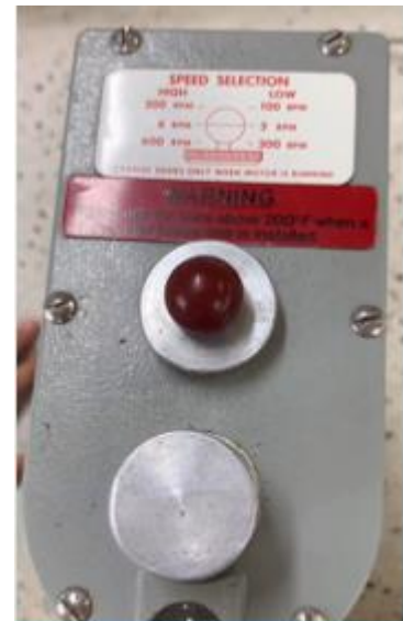
Mover la palanca de cambio para las velocidades de corte
