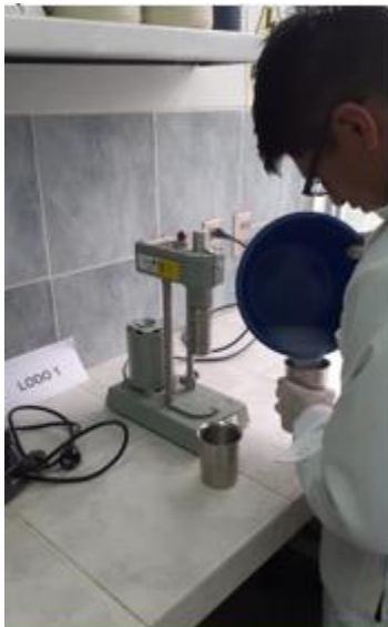
Verter el lodo en el vaso del viscosímetro
