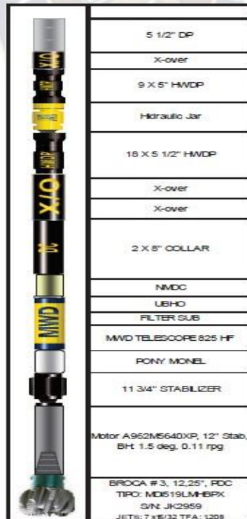
Figura 12. BHA con motor de fondo
