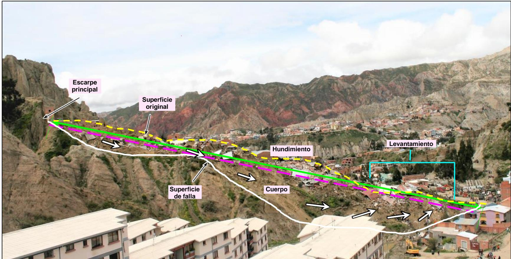
Fotografía 14. Perfil longitudinal del deslizamiento tipo rotacional – Huanu huanuni (elaboración propia).
