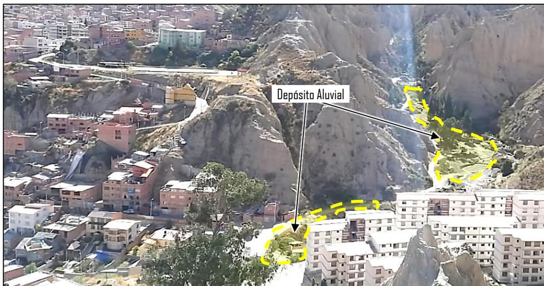
**Fotografía 7. Deposito aluvial – Norte del deslizamiento (elaboración propia)**
