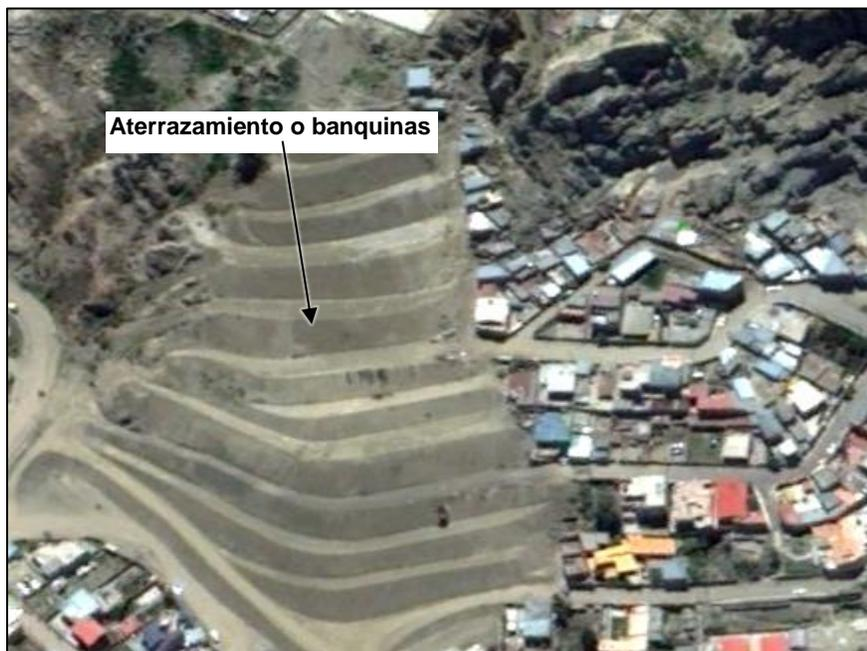
Fotografía 23. Banquinas de estabilización del deslizamiento de Huanu Huanuni (Guzmán, 2016).
