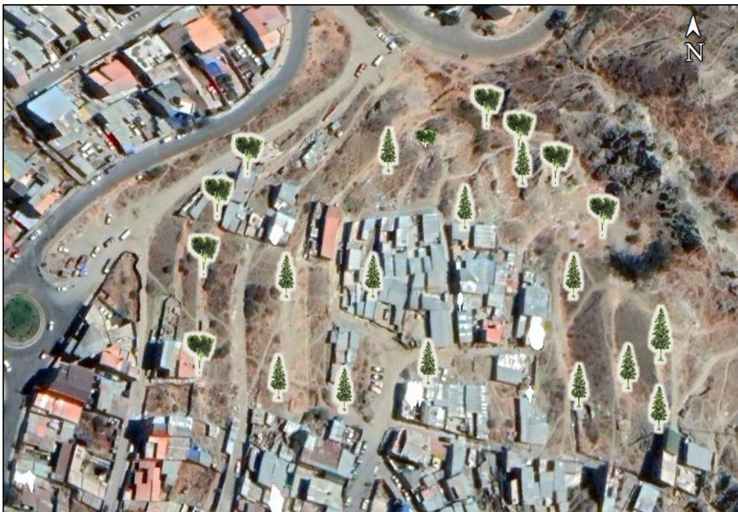
**Figura 32. Distribución de árboles de eucaliptos y pinos para mejorar la estabilidad del deslizamiento**
