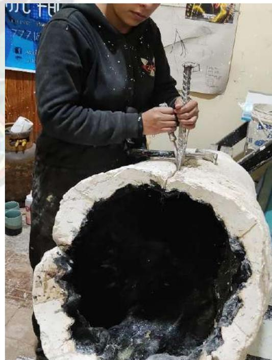
*Ilustración 109. Palanqueado de apertura*
