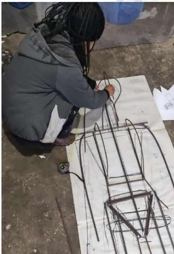
*Ilustración 30. Armado de estructura*
