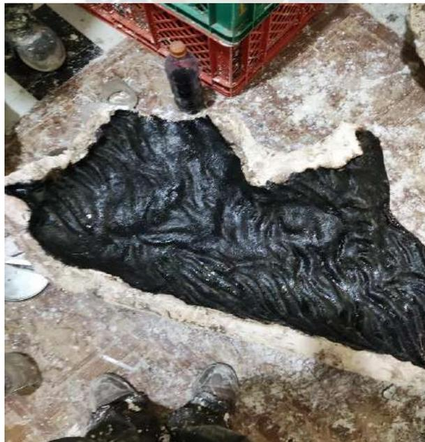
*Ilustración 99. Gel Coat sobre molde*
