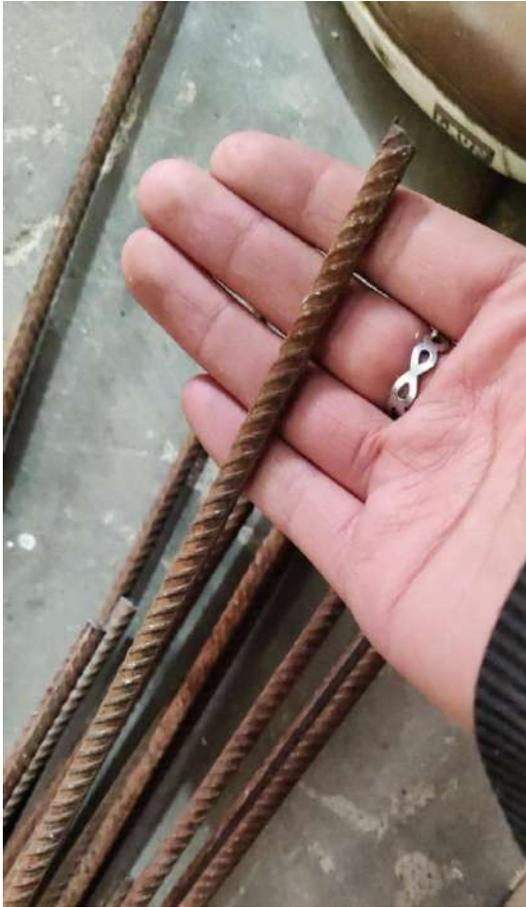
*Ilustración 28. Acopio de fierros de construcción  $\frac{1}{4}$*
