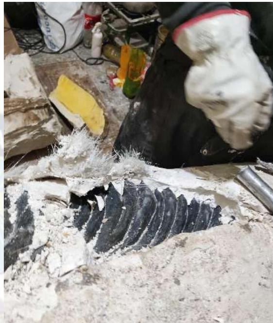
*Ilustración 107. Desmoldado en diagonal*
