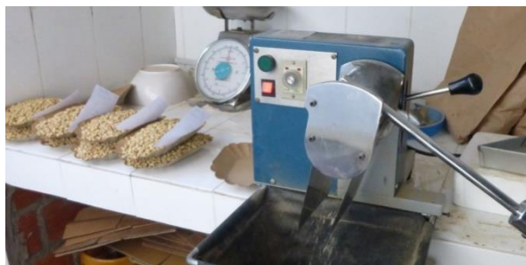
Figura 14. Despergaminadora mecánica de café
