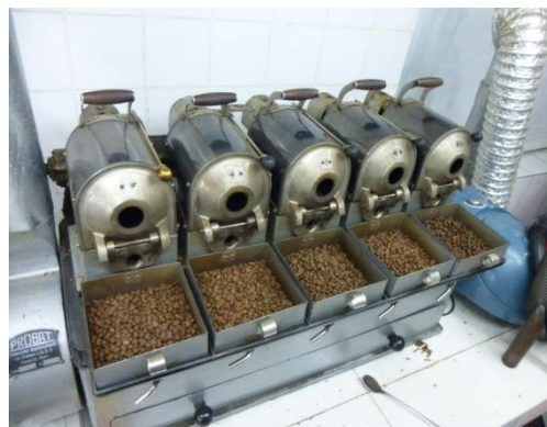
Figura 23. Tostador mecánico de café
