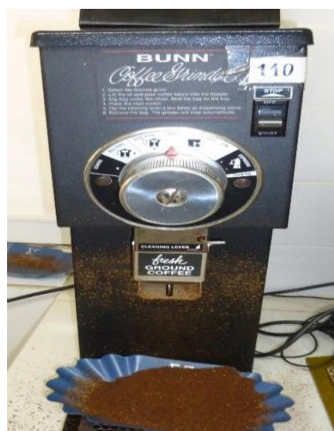
Figura 24. Molino mecánico de café
