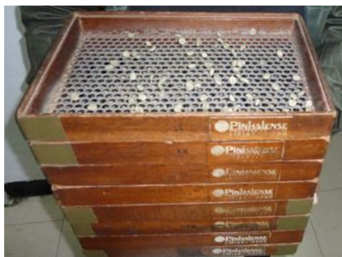
Figura 15. Tamizadora o zaranda de café
