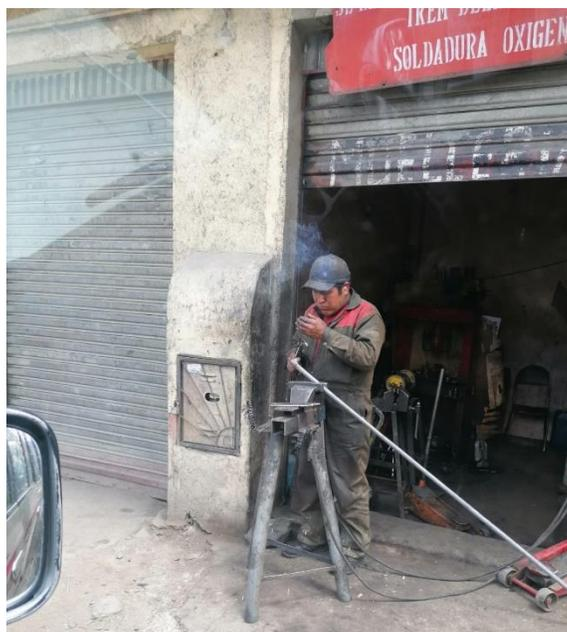
Imagen N<sup>o</sup>4. Operador en exposición de humos y gases nocivos para su salud, sin protección visual, sin mascarillas.
