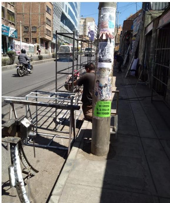
Imagen N<sup>o</sup> 3. Se observa los trabajos realizados en invasión de las vías públicas sin señalización., trabajo con equipo de soldar sin protección.
