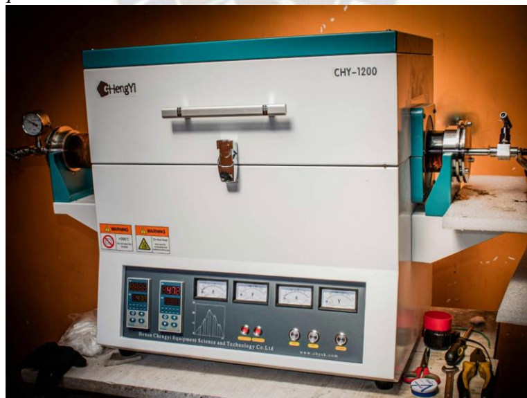
Horno reactor de pirólisis
