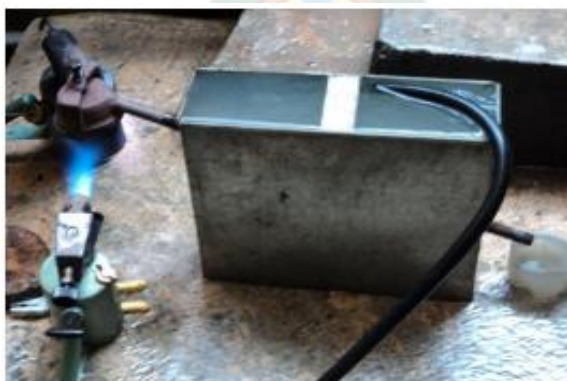
Figura 14. Recuperador de Mercurio o Retorta
