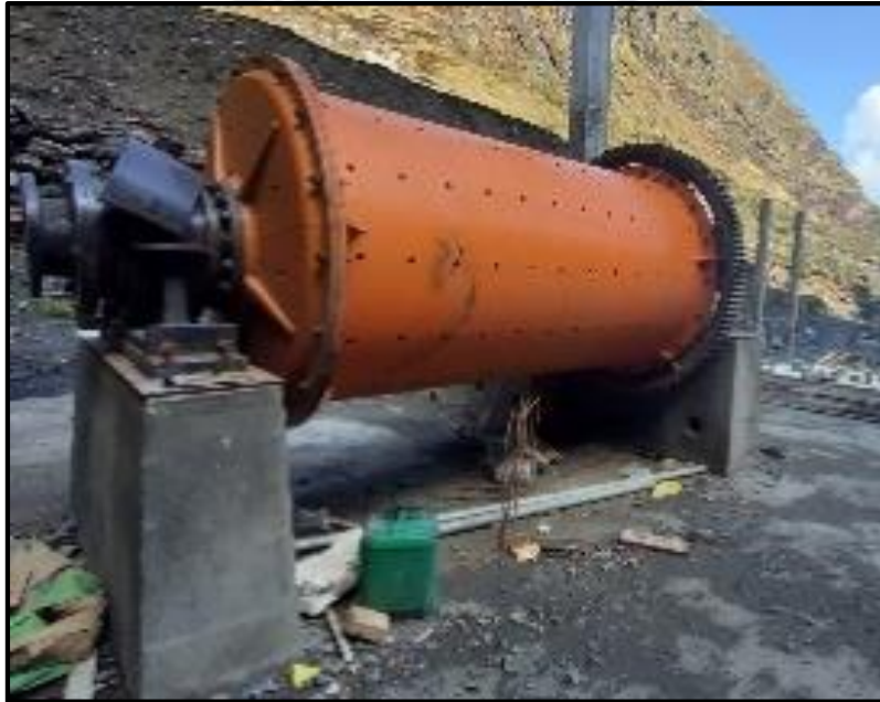
Figura 10. Características del molino de bolas
