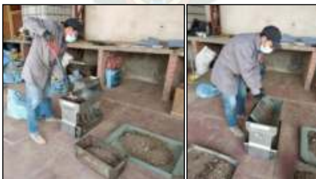
Figura 23. Equipo y procedimiento del Cuarteo Mecánico Fuente: Elaboración Propia, Laboratorio ABC
