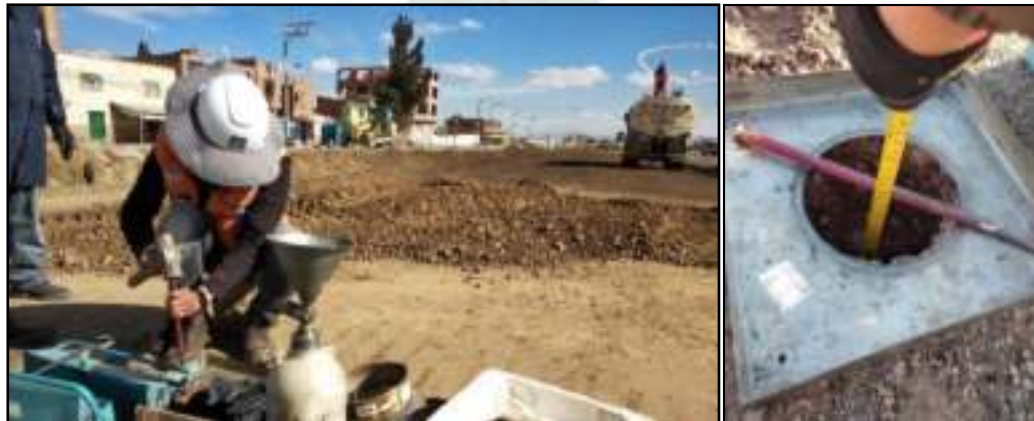
Figura 53. Excavación del suelo Fuente: Elaboración Propia
