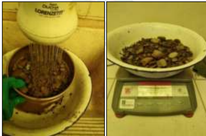
Figura 27. Lavado parte gruesa Fuente: Elaboración Propia, Laboratorio ABC
