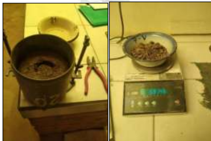
Figura 47. Verificación de la penetración en el suelo, determinación de su humedad Fuente: Elaboración Propia, Laboratorio ABC
