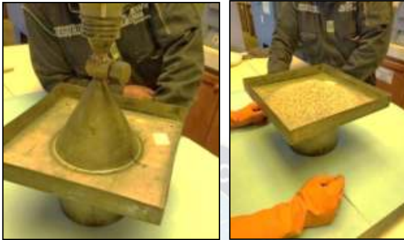
Figura 52. Procedimiento para determinar la densidad de la arena Fuente: Elaboración Propia
