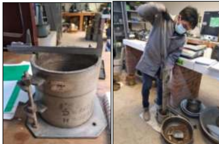
Figura 38. Verificación del molde, compactado de la muestra Fuente: Elaboración Propia, Laboratorio ABC
