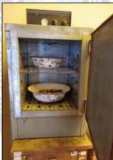
Figura 29. Secado de la muestra Fuente: Elaboración Propia, Laboratorio ABC
