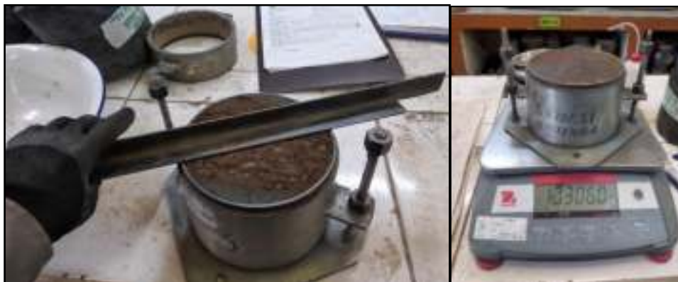
Figura 39. Enrasado de la muestra Fuente: Elaboración Propia, Laboratorio ABC
