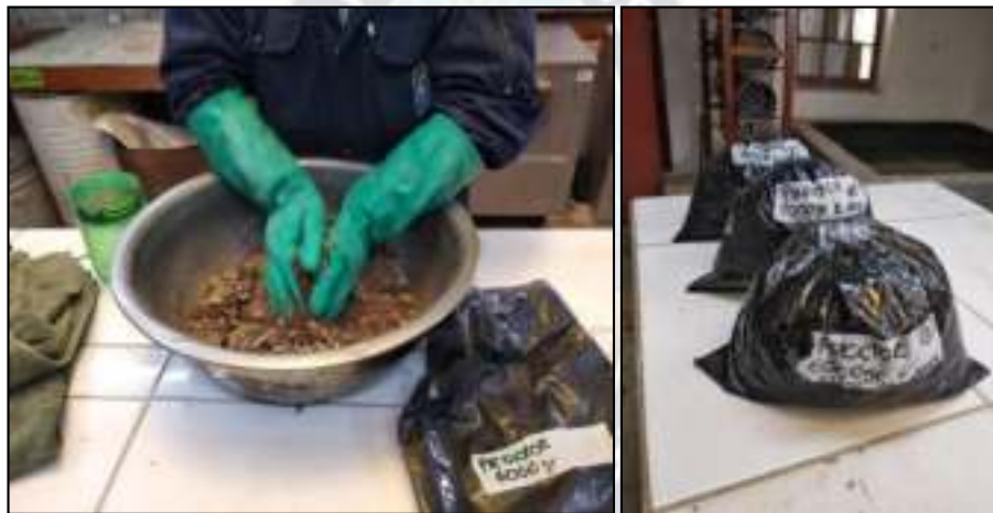
Figura 37. Mezclado de la muestra Fuente: Elaboración Propia, Laboratorio ABC
