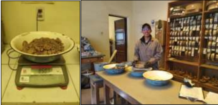
Figura 25. Separación parte gruesa y fina Fuente: Elaboración Propia, Laboratorio ABC
