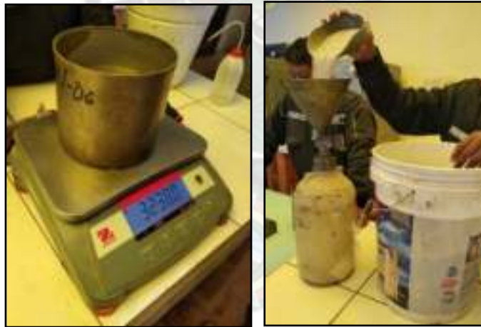
Figura 51. Molde y Llenado del aparato Fuente: Elaboración Propia
