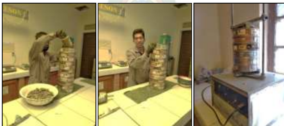
Figura 30. Tamizado manual y automático de la muestra Fuente: Elaboración Propia, Laboratorio ABC
