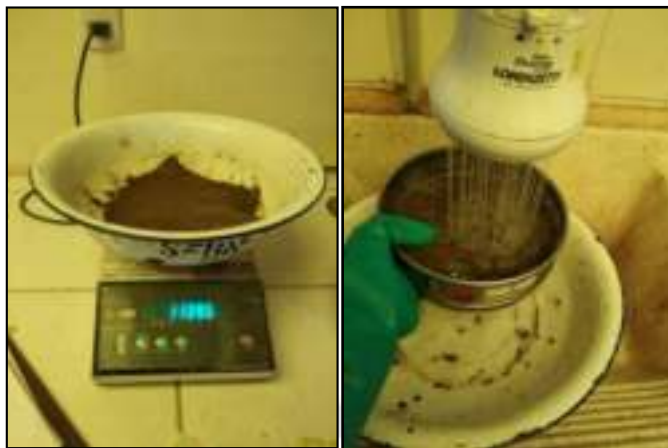
Figura 28. Lavado parte fina Fuente: Elaboración Propia, Laboratorio ABC
