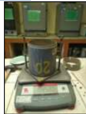
Figura 43. Determinación de la masa total Fuente: Elaboración Propia, Laboratorio ABC
