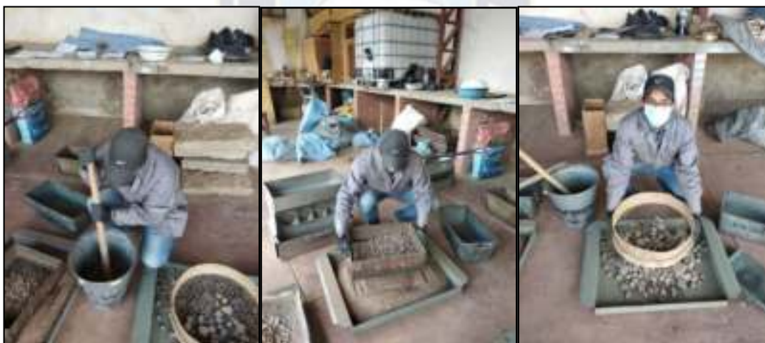
Figura 35. Separación de la muestra en los tamices Fuente: Elaboración Propia, Laboratorio ABC
