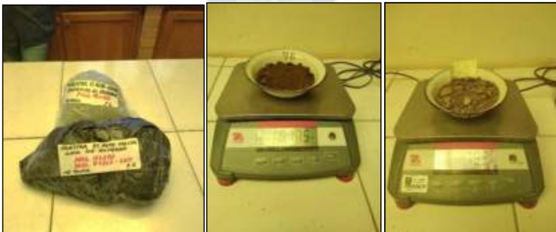
Figura 55. Determinación del contenido de humedad Fuente: Elaboración Propia
