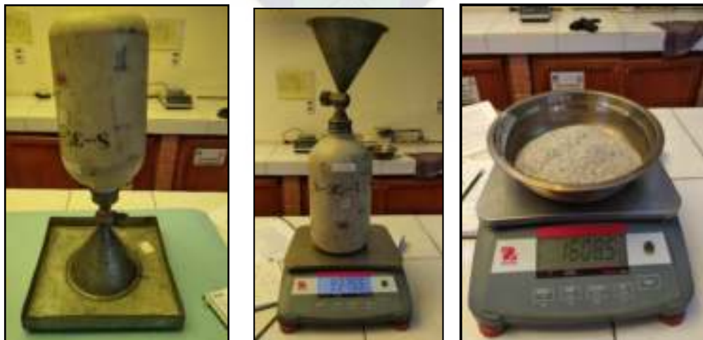
Figura 50. Procedimiento para la determinación de la masa del cono Fuente: Elaboración Propia
