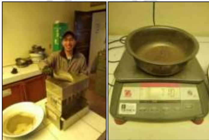
Figura 26. Cuarteo de la parte fina Fuente: Elaboración Propia, Laboratorio ABC
