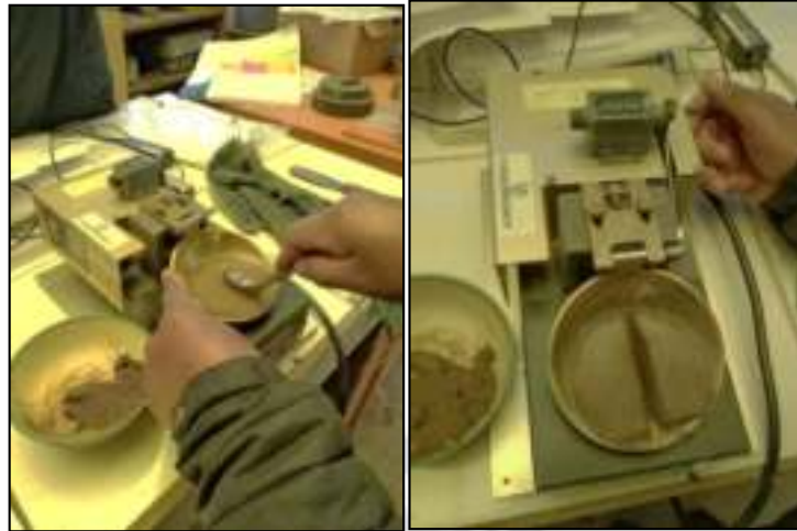
Figura 32. Porción de muestra colocada en copa de Casagrande Fuente: Elaboración Propia, Laboratorio ABC
