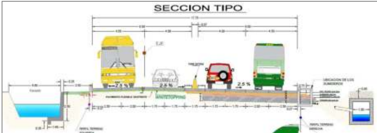
Figura 11. Sección Tipo de la Vía El Alto – Viacha Fuente: Empresa Boliviana de Construcción (EBC)
