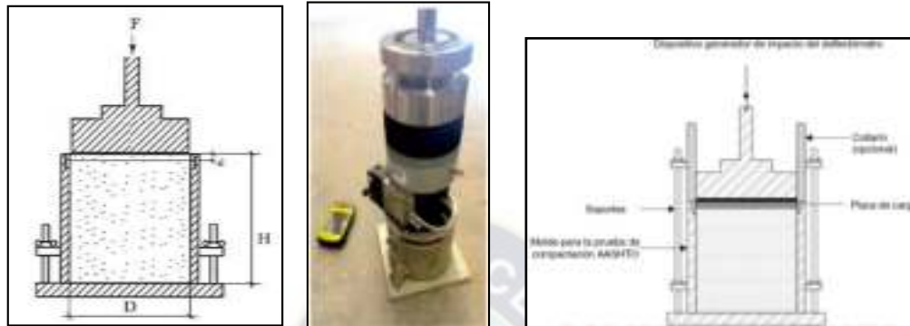
Figura 69. Equipo LWD sobre molde AASHTO
