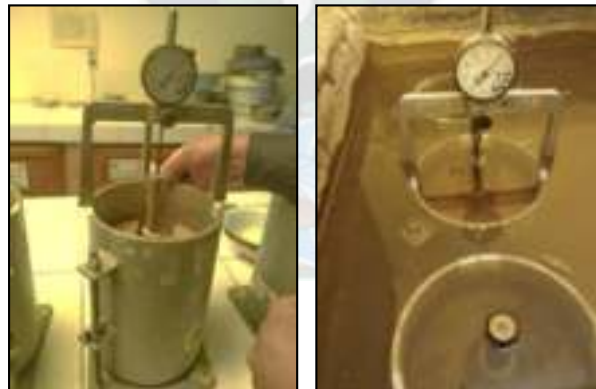
Figura 44. Lectura del dial al inicio Fuente: Elaboración Propia, Laboratorio ABC
