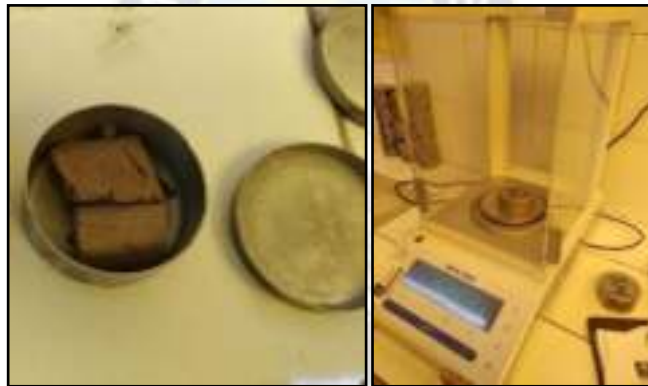
Figura 33. Determinación de la masa de suelo con recipiente Fuente: Elaboración Propia, Laboratorio ABC
