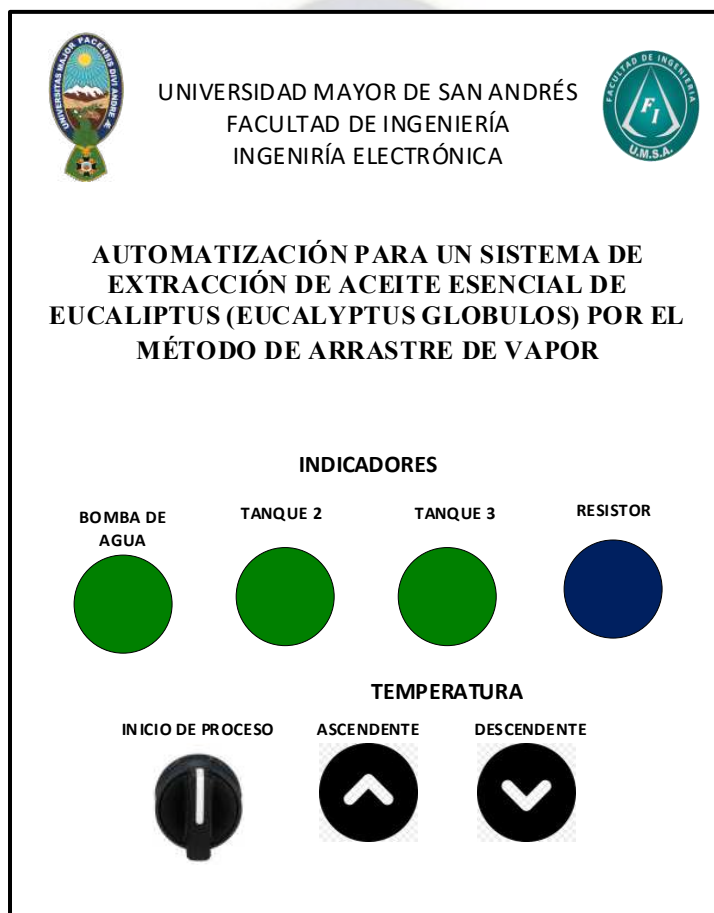
Figura 26 - Tablero de control del proceso
