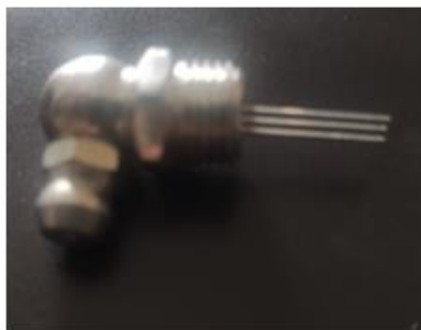
Figura 53 - Sensor de temperatura LM35 para el tanque 2.
