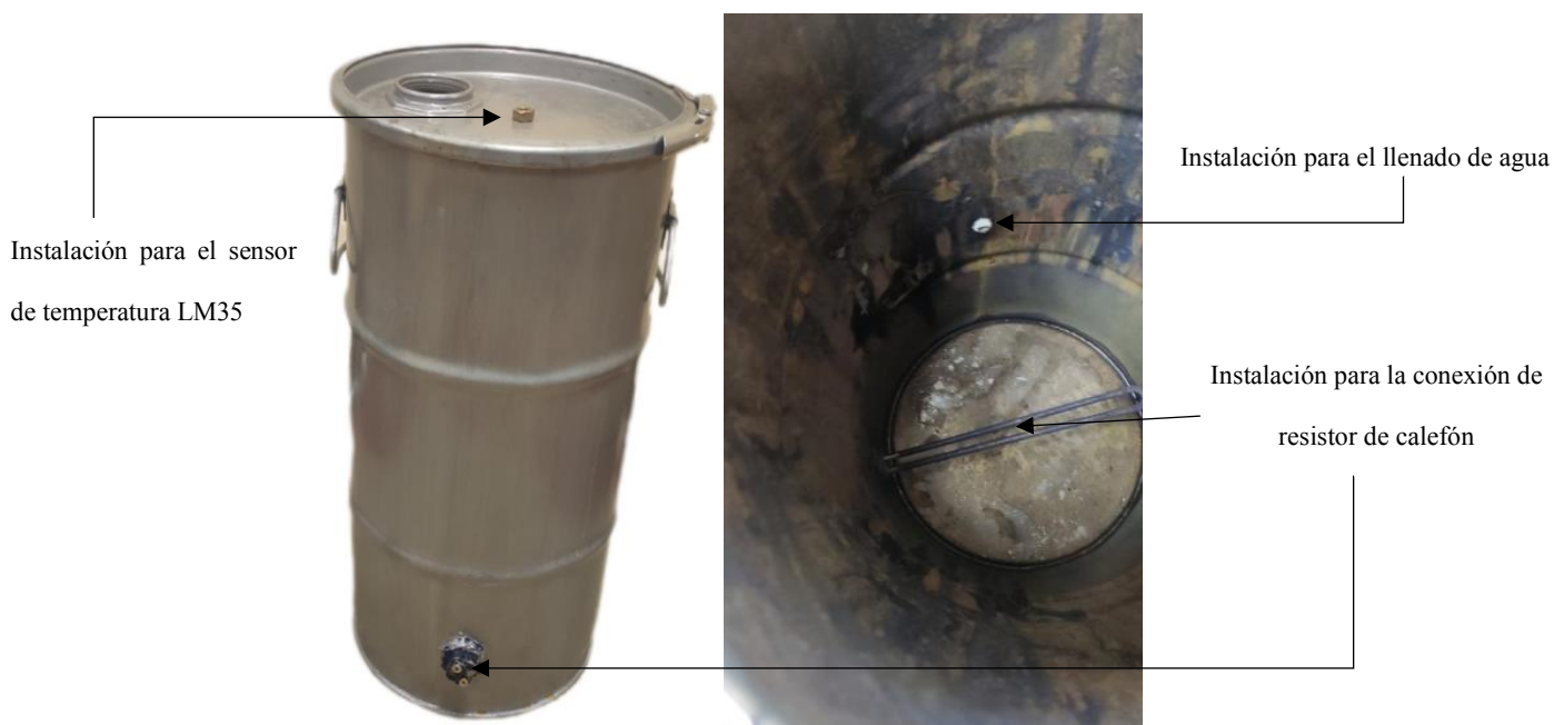
Figura 51 - Conexiones realizadas en el tanque 2
