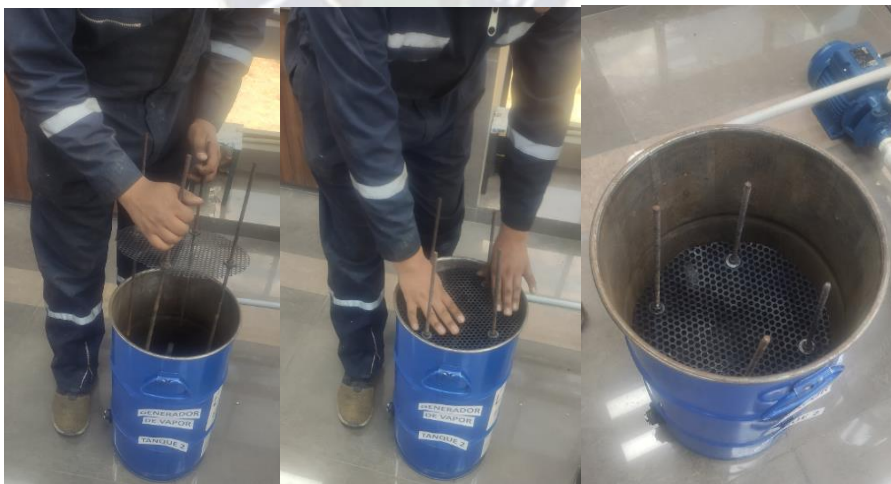
Figura 61 - Tanque 2 con la placa perforada
