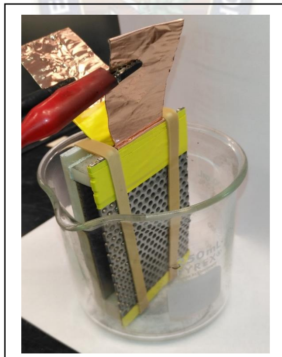
Figura 22 Ensamblado final de los electrodos para la EPD
