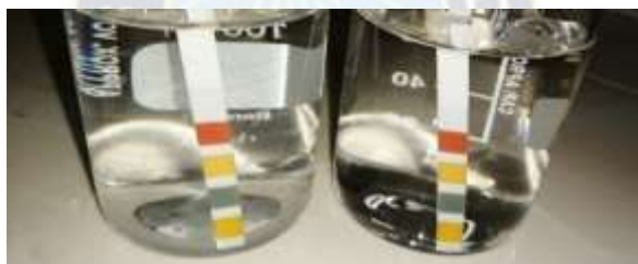
Figura 3.20 Vasos de Precipitado, Izq.: Agua Desionizada, Der.: Agua del Ultimo Lavado
