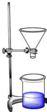
Figura 3.15 Equipo de Filtración
