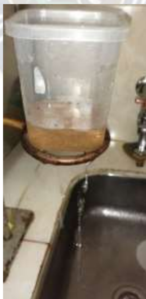
Figura 3.18 Lavado del PS Sulfonado en Recipiente de Plástico
