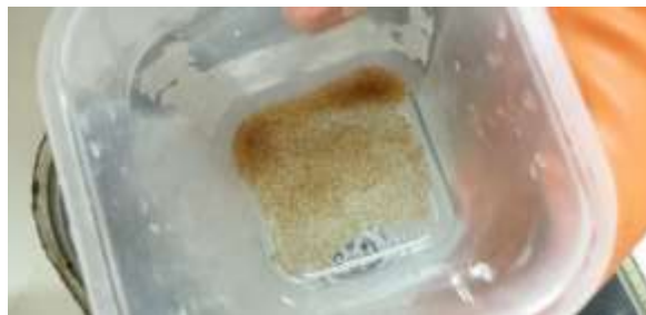
Figura 3.19 PS Sulfonado Separado y Adecuado en Recipiente de Plástico
