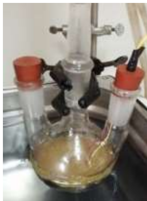
Figura 3.13 Balón de Vidrio con Poliestireno Sulfonado
