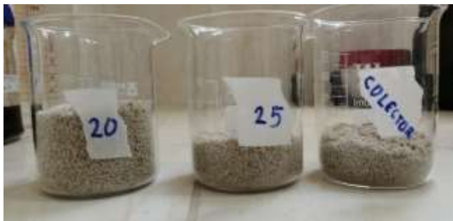
Figura 3.8 Masas de Poliestireno Coagulado Tamizadas
