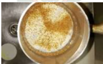
Figura 3.16 Lavado del PS Sulfonado en Embudo de Acero Inoxidable
