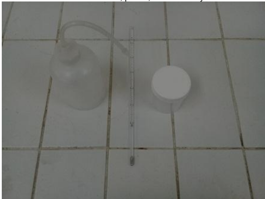
Fotografía N°4 - Materiales de laboratorio, piseta, termómetro y frasco de muestras
