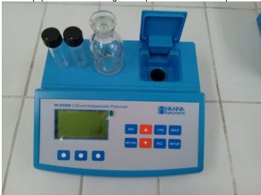
Fotografía N°6 - Equipo de análisis de aguas. Espectrofotómetro multiparamétrico
