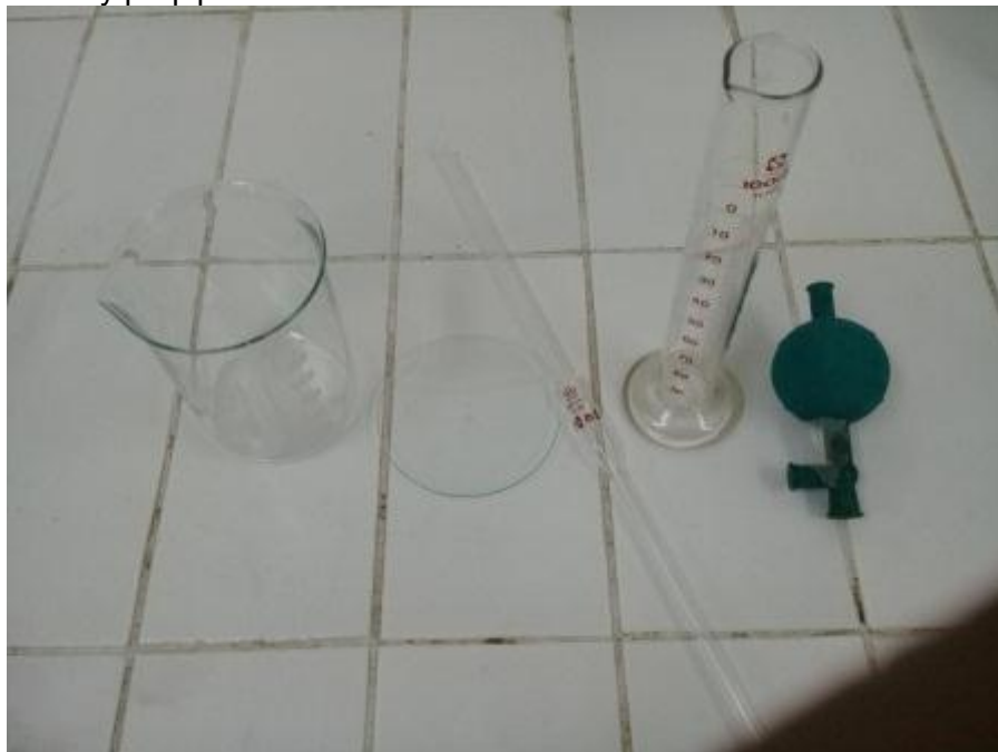
Fotografía N°5 - Materiales de laboratorio. Vaso de precipitados, vidrio reloj, pipeta aforada, probeta y propipeta
