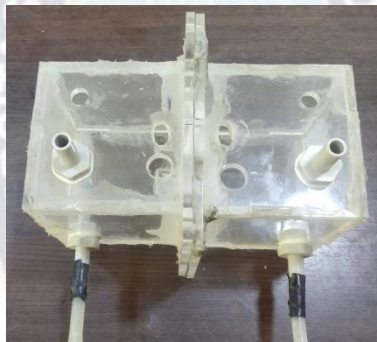
Figura 3.6 Parte superior de la celda con los conectores rosca
