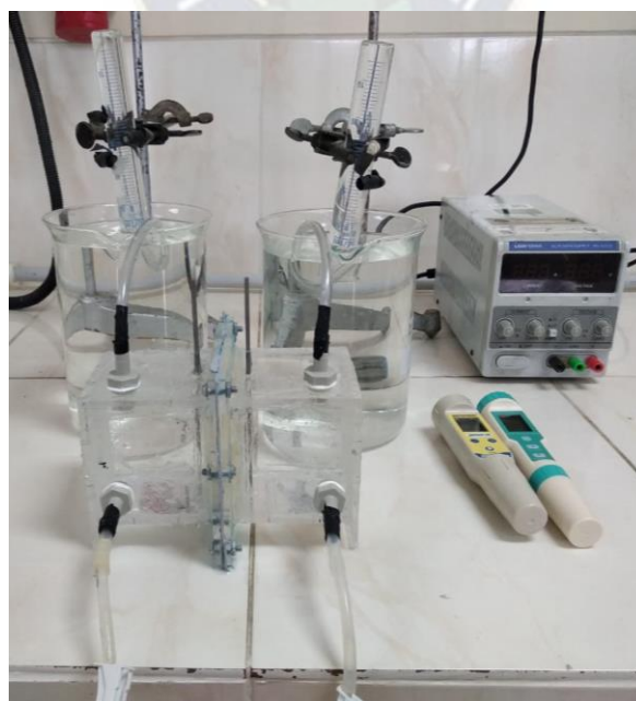
Figura 3.10 Montaje final del sistema de producción de agua alcalina ionizada
