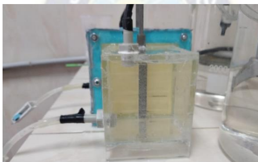
Figura 3.9 Instalación de la membrana y electrodos
