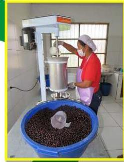
**DESPULPADO.** Para el despulpado de las frutas se usan equipos conocidos como despulpadoras de cilindro vertical o bataderas. Estos equipos usan un movimiento rotatorio que hace que se separe la pulpa de las semillas y la cáscara. Se echa agua según la cantidad y calidad de pulpa que se requiere. En el mercado las pulpas de mayor espesor son más valoradas porque rinden más jugo.
