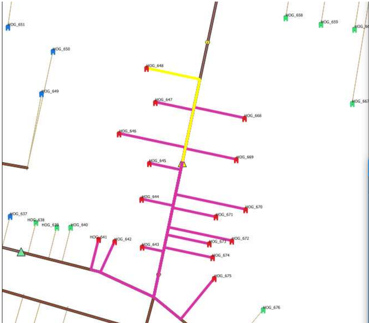
Figura 52 Fibra al hogar y ONT's Fuente: Elaboración propia
