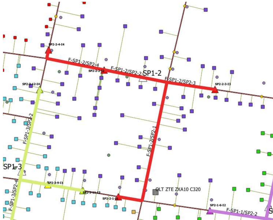
Figura 51 Fibra de distribución (color rojo) Fuente: Elaboración propia
