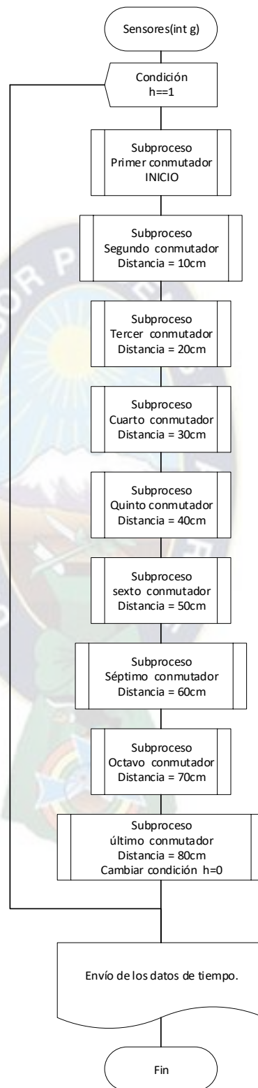
Fig. 3.27. Diagrama de flujo – Función “Sensores(int g) Fuente: Elaboración Propia mediante herramienta Microsoft office Visio 2016
