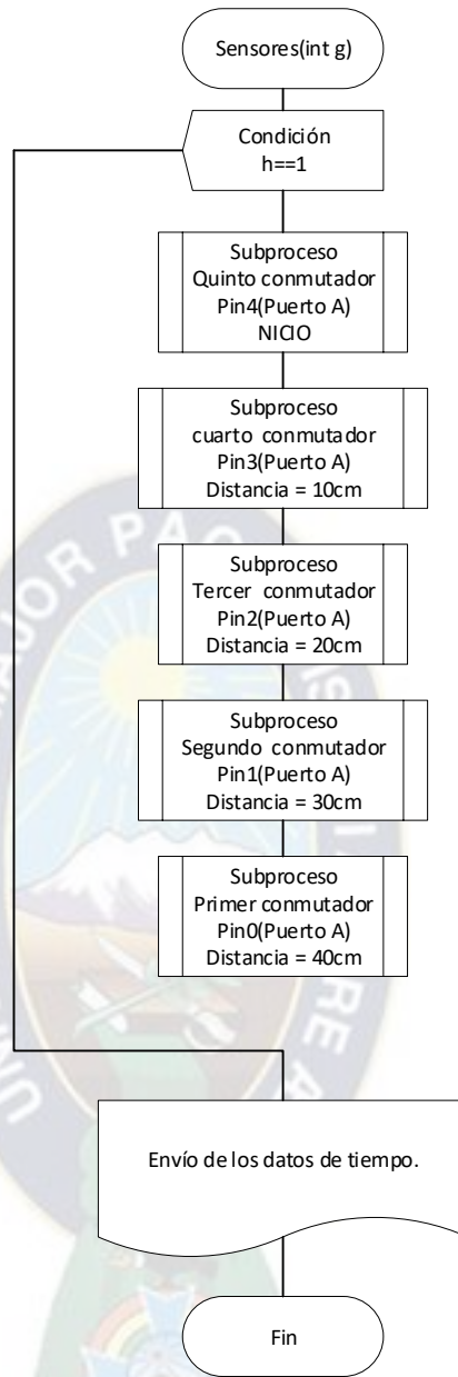
Fig. 3.32. Diagrama de flujo – Función “Lab3(int h)” Fuente: Elaboración Propia mediante herramienta Microsoft office Visio 2016
