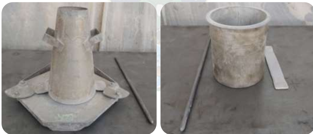
Figura N° 3-12: Equipos para realizar el ensayo de consistencia y peso unitario del hormigón fresco Fuente: Elaboración propia, 2023
