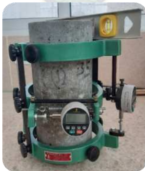
Figura N° 3-22: Preparación de la probeta para el ensayo de módulo de elasticidad
