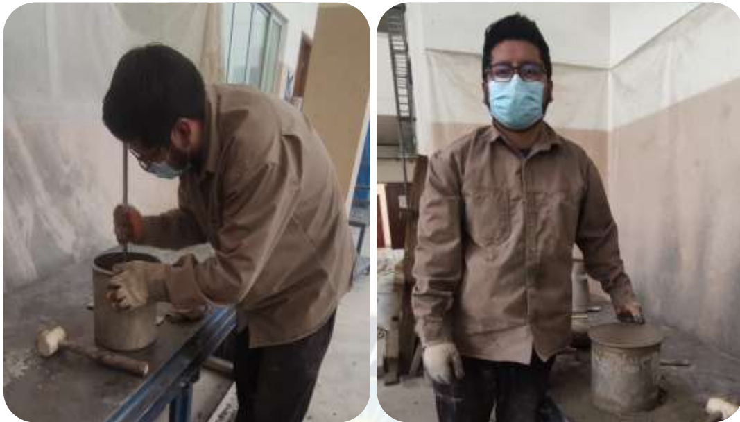
Figura N° 3-15: Ejecución del ensayo de peso unitario del hormigón fresco según la norma ASTM C 138 Fuente: Elaboración propia, 2023
