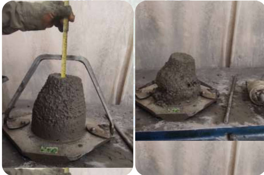
Figura N° 3-14: Medida de la consistencia del hormigón fresco según ASTM C 143
