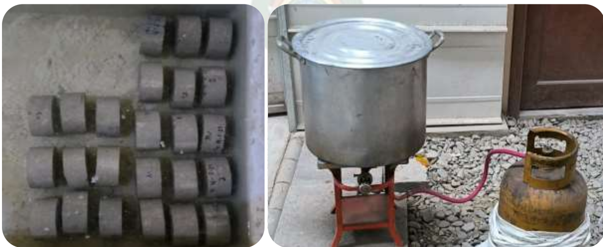
Figura N° 3-26: Inmersión y ebullición en agua de las muestras de cada hormigón Fuente: Elaboración propia, 2023
