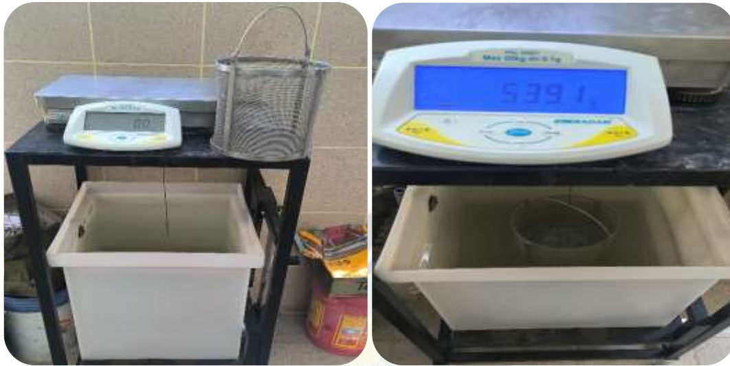
Figura N° 3-27: Determinación de la masa sumergida aparente de las muestras de cada hormigón Fuente: Elaboración propia, 2023
