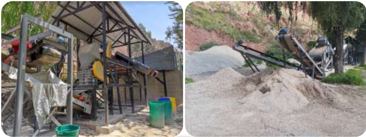
Figura N° 3-2: Planta procesadora de escombros Fuente: Elaboración propia, 2023
