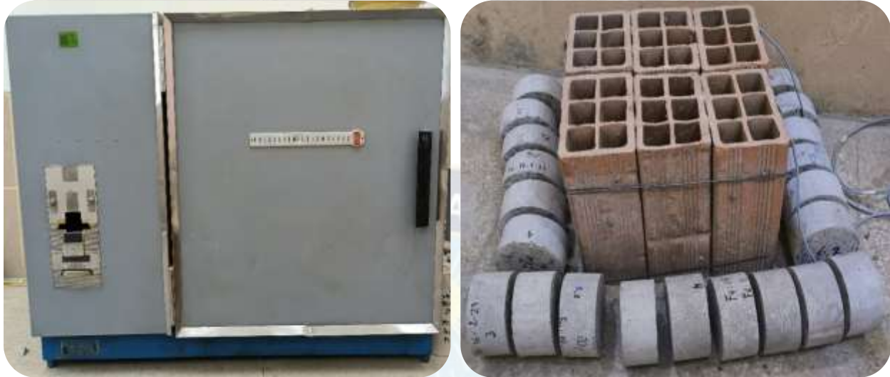
Figura N° 3-25: Secado de las muestras de cada hormigón Fuente: Elaboración propia, 2023
