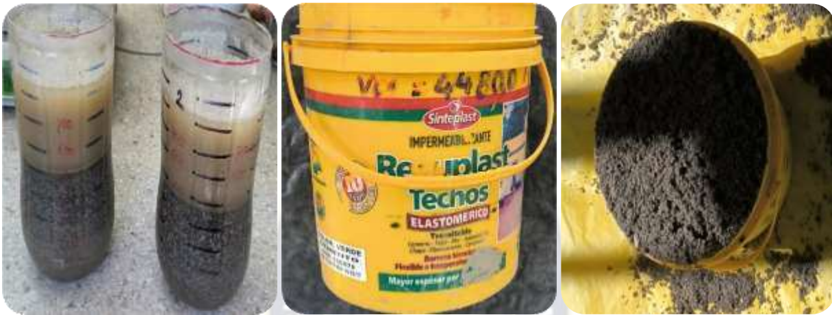
Figura N° 3-21: Determinación del esponjamiento de la arena y llenado de los agregados en el recipiente (balde)
