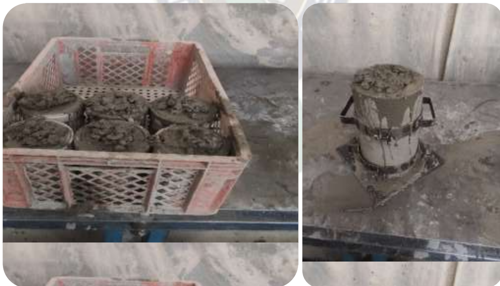
Figura N° 3-16: Llenado de las probetas con el hormigón fresco Fuente: Elaboración propia, 2023
