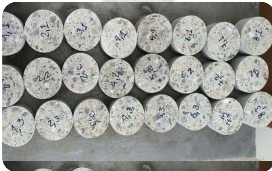
Figura N° 3-24: Muestras de cada hormigón para realizar el ensayo ASTM C 642 Fuente: Elaboración propia, 2023
