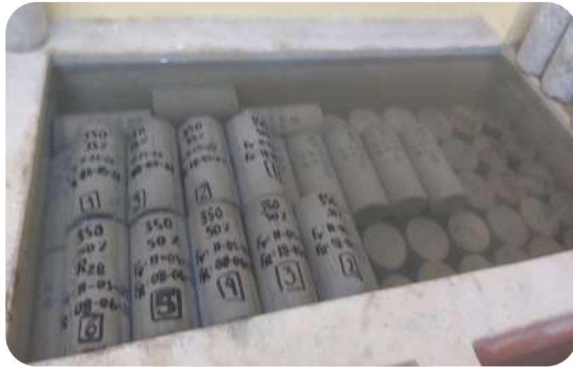
Figura N° 3-19: Curado de las probetas en piscina
