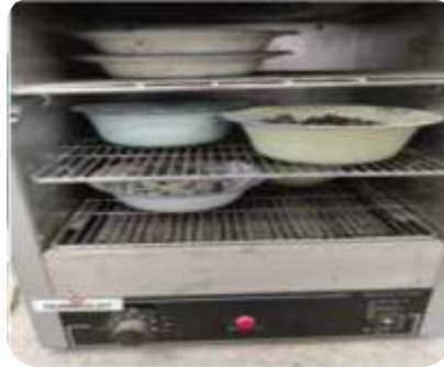
Figura N° 3-11: Determinación de la humedad de los agregados Fuente: Elaboración propia, 2023
