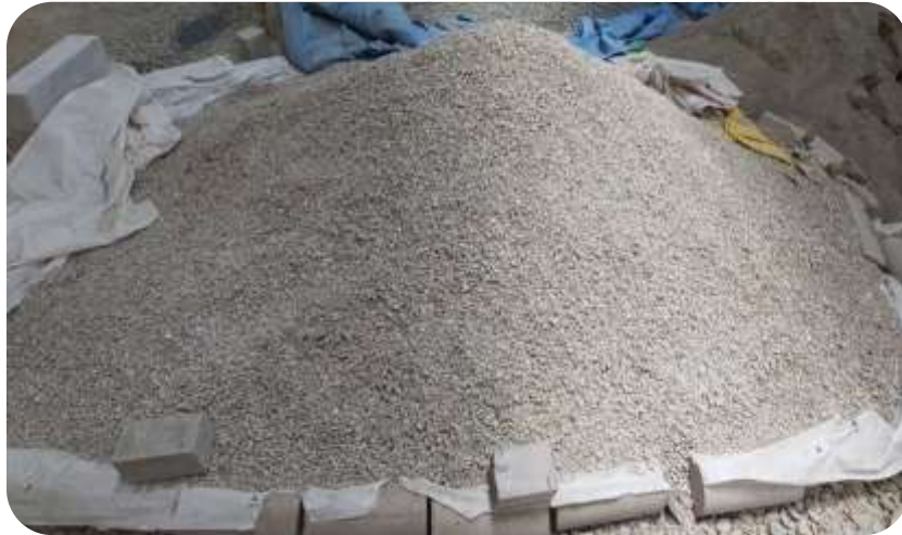
Figura N° 3-7: Agregado grueso reciclado (RCD) en el Instituto de Ensayo de Materiales (IEM) Fuente: Elaboración propia, 2023
