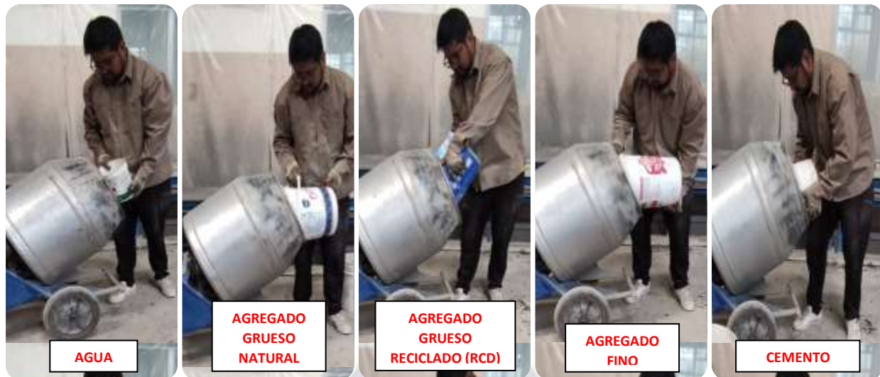
Figura N° 3-13: Colocación de los materiales dentro de la mezcladora
