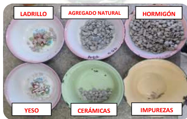
Figura N° 3-8: Materiales encontrados en el agregado grueso reciclado (RCD) Fuente: Elaboración propia, 2023
