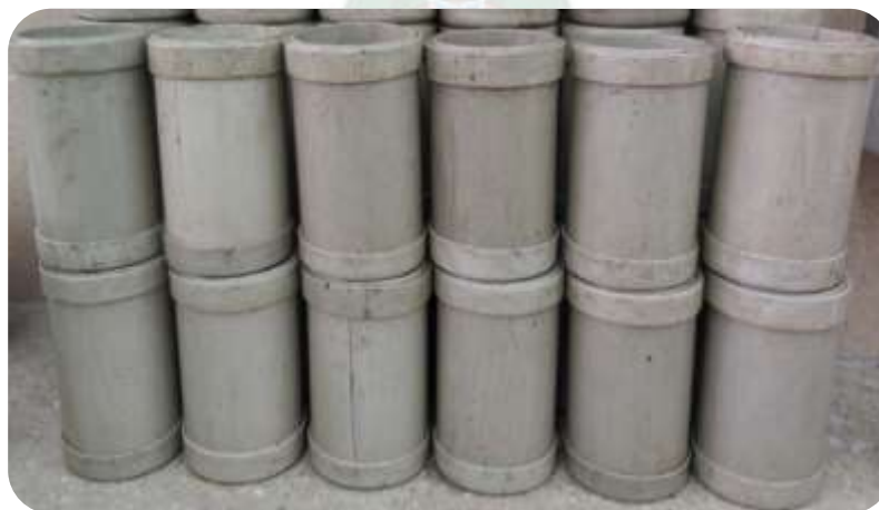
Figura N° 3-10: Probetas cilíndricas 10x20 cm según la norma ASTM C 470
