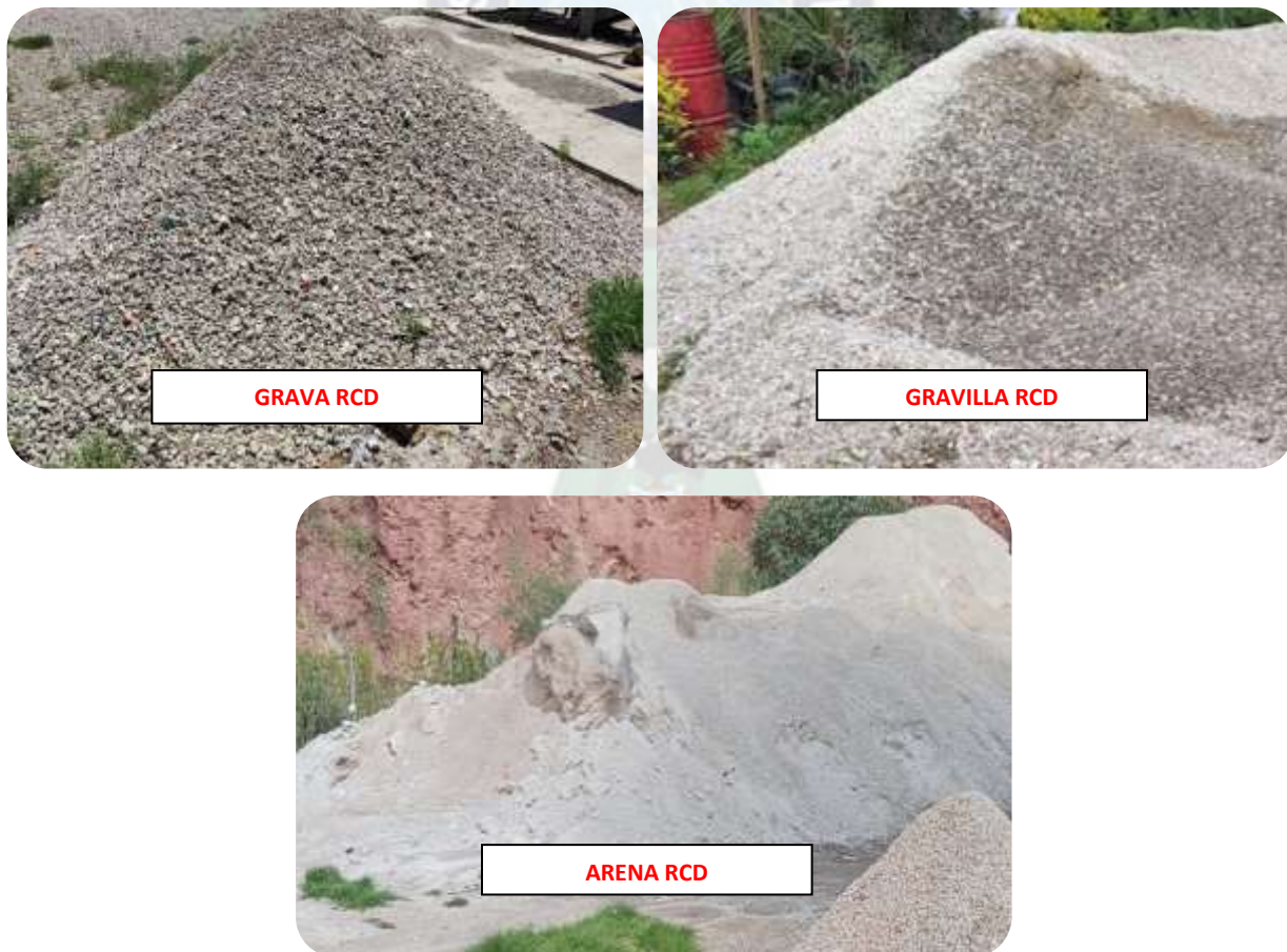
Figura N° 3-3: Grava, gravilla y arena reciclada (RCD) en la planta de transformación de escombros Fuente: Elaboración propia, 2023
