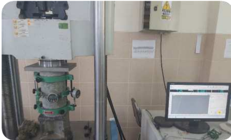
Figura N° 3-23: Ejecución del ensayo de módulo de elasticidad según la norma ASTM C 469 Fuente: Elaboración propia, 2023
