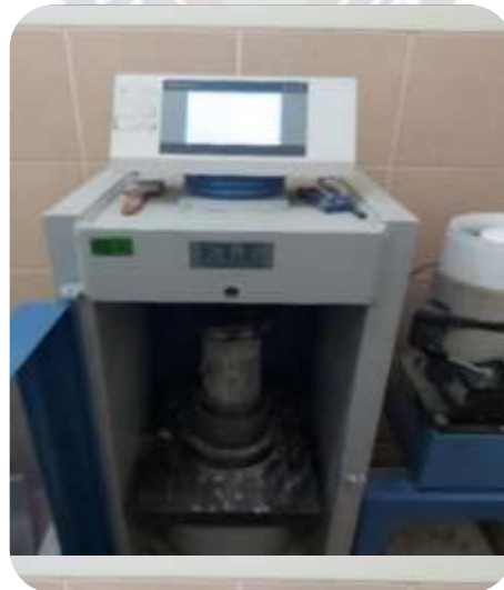
Figura N° 3-20: Ensayo a compresión en probetas cilíndricas
