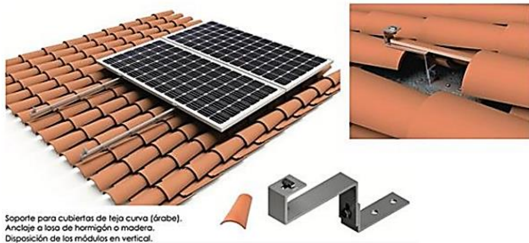
Figura 27: Soporte coplanar continuo con salvatejas-gancho para cubierta de teja. Vertical
