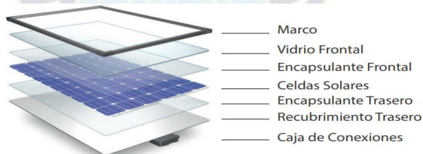
Figura 22: Componentes de un panel fotovoltaico
