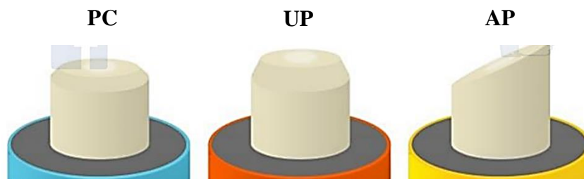
Figura 21. Pulidos de Conectores Ópticos
