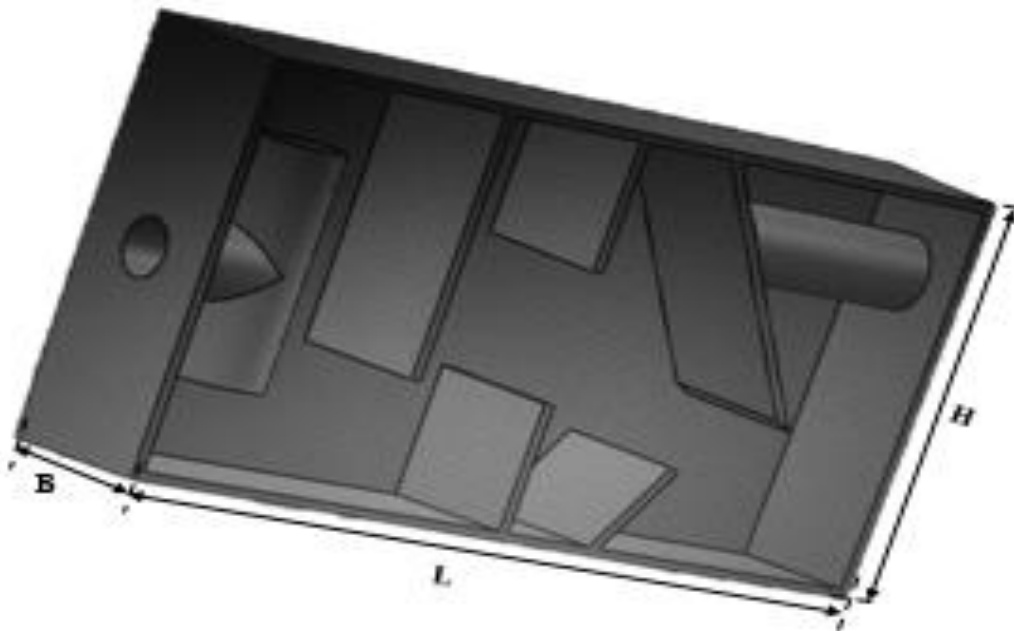
FIGURA 3 Imagen de la trampa de grasas
