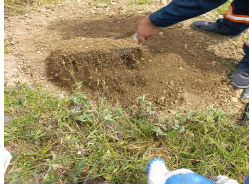
Figura 4. Mezclando la muestra de suelo.
