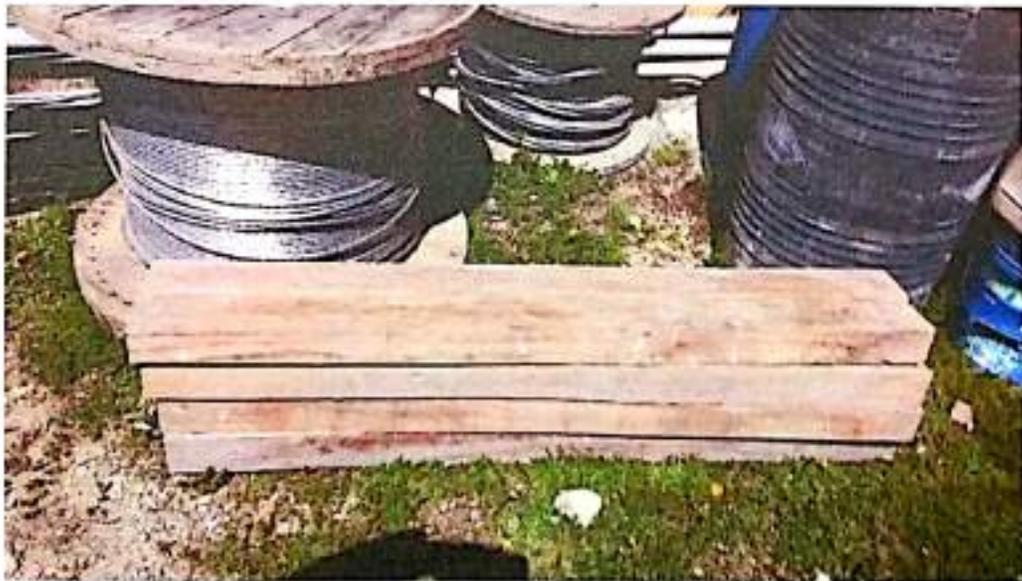
**CRUCETAS Y BOBINAS DE CONDUCTOR PARA LA RED DE MT Y BT**
