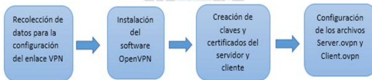
Figura 34. Diagrama de bloques para la elaboración del diseño VPN
