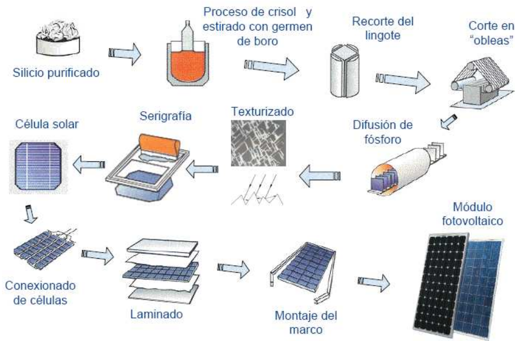
Ilustración 37 Proceso de fabricación módulos fotovoltaicos.
