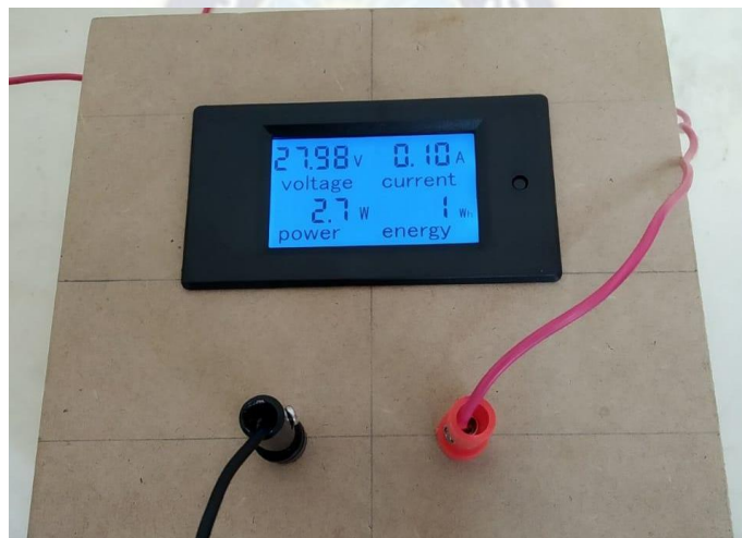
Ilustración 41 Medidor de energía en corriente directa.
