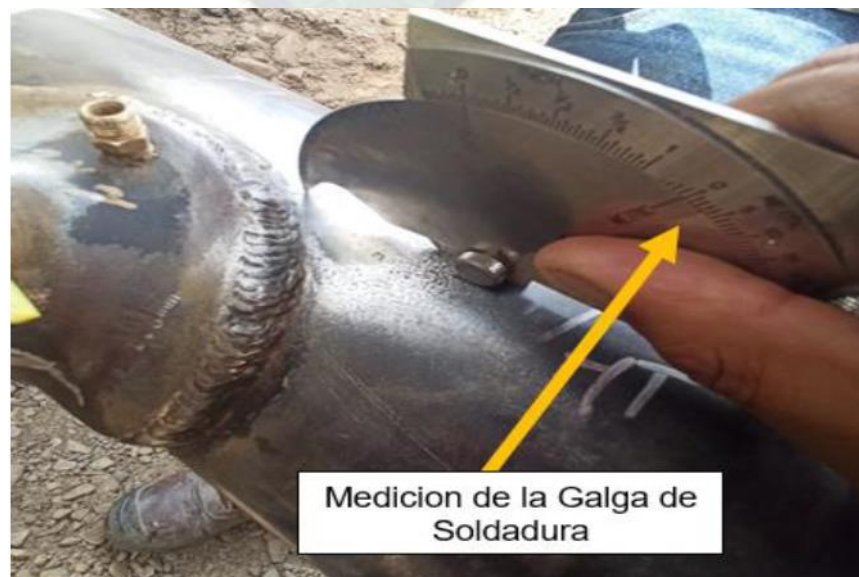
Figura 34. Medición de profundidad de discontinuidad
