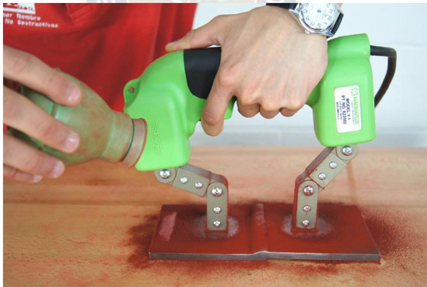
Figura 8. Magnetización local producida con puntas
