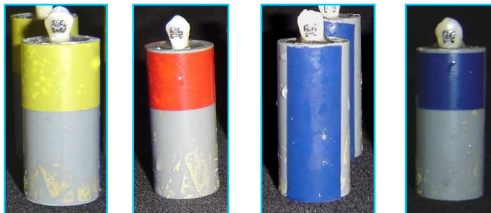
Fig. 36, ,37,38 y 39 Marcado con cinta adhesiva de color (amarilla -Transbond XT, roja - Fuji LC, Azul - UNICEM sin grabado acido y azul en forma vertical - UNICEM con grabado acido)
