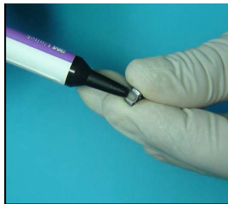
Fig. 10 y 11 Aplicación de la resina Transbond XT en la base del bracket
