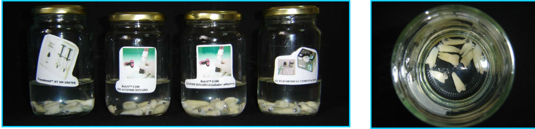
Fig. 31 Las piezas se mantuvieron en solución de suero fisiológico para controlar las condiciones de humedad
