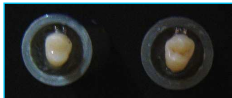
Fig. 34 y 35 - 2/3 se relleno con yeso extraduro, terminado con acrílico autopolimizable
