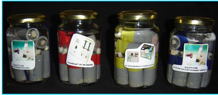
Fig 40 Muestras mantenidas en suero fisiológico para el control de la humedad
