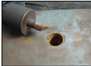
Fig. 41 y 42 Dispositivos de acero: Una base de 2cm. de ancho por 22cm. de largo Y un vástago con una terminación en bisel
