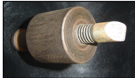
Fig. 41 y 42 Dispositivos de acero: Una base de 2cm. de ancho por 22cm. de largo Y un vástago con una terminación en bisel
