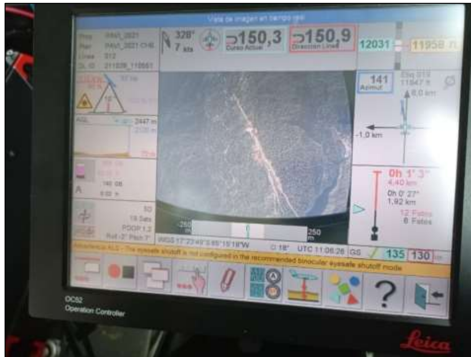
Figura 36. Control de vuelo, verificación de altitud, dirección y velocidad Fuente: Elaboración propia
