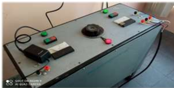
Figura 5.2. Fuente trifásica regulable Fuente: Laboratorio Circuitos Electricidad Industrial UMSA
