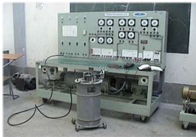
Figura 5.6. Entrenador de motor de 2.2 kW de CA adaptado para pruebas Fuente: Escuela Industrial Pedro Domingo Murillo
