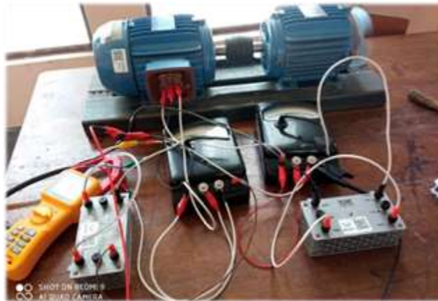
Figura 5.1. Ensayo de vacío y rotor trabado en el motor de inducción 3 HP Fuente: Laboratorio Circuitos, Electricidad Industrial UMSA
