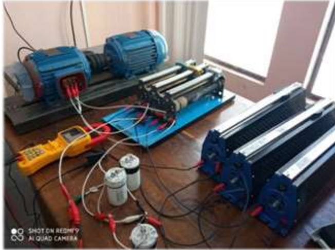
Figura 5.13. Generador de Inducción de prueba Fuente: Elaboración propia
