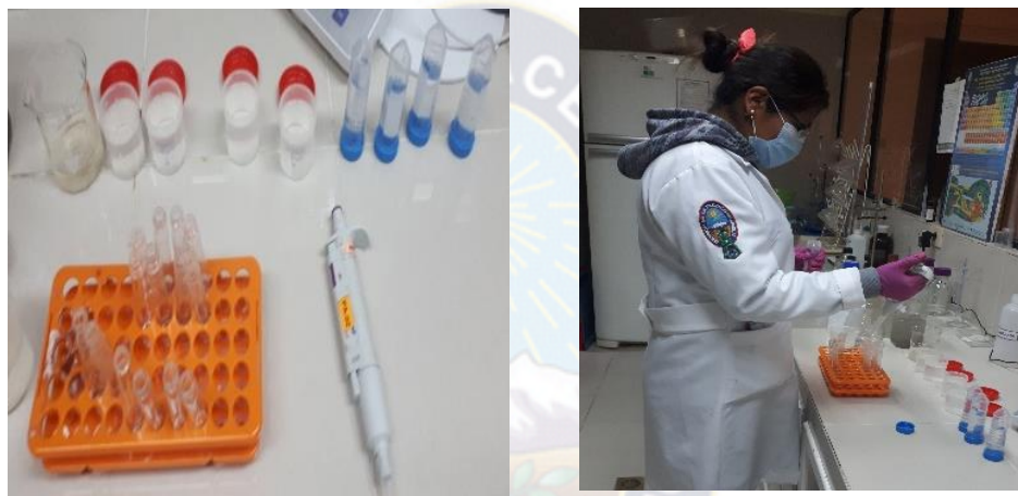
Figura 25: Preparación de la muestra para la digestión de DQO a 150 °C
