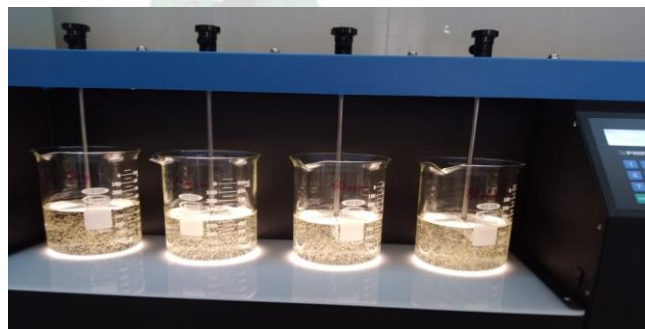
Figura 19: Mezcla de agitación lenta después de la aplicación del coagulante.
