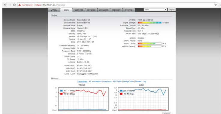
Figura 5.25 Estado de enlace Calle 6 Intersección
