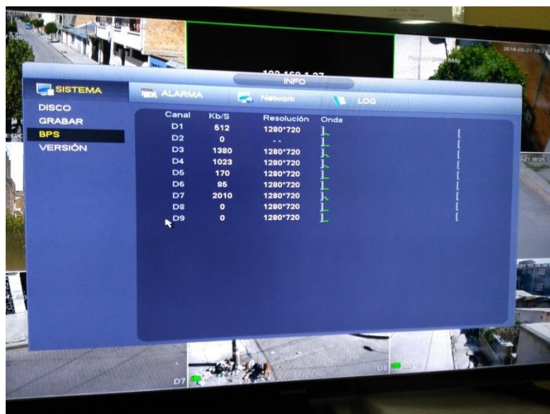
Figura 5.52 Taza de Rendimiento por cámara
