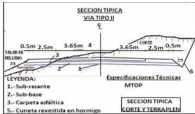
Gráfico N° 4 Sección Corte de Terraplén
