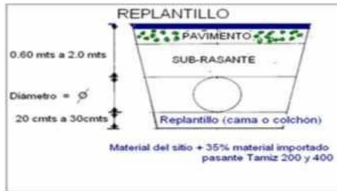
Gráfico N° 8 Relleno de Material
