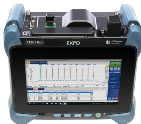
Figura 31 –Equipo Analizador de espectro óptico OSA Exfo.
