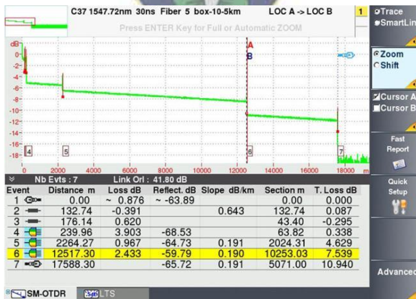
Figura 39 –Medición con OTDR DWDM.
