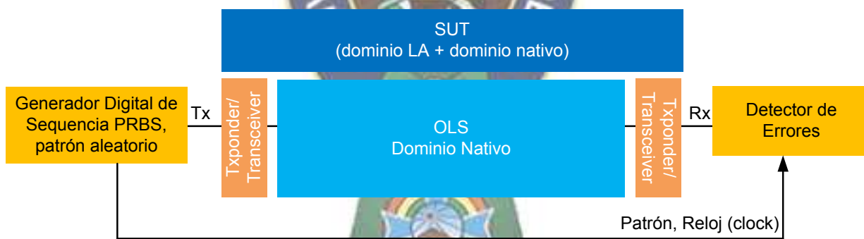
Figura 40 –Medición de BER en la solución lambda alien.
