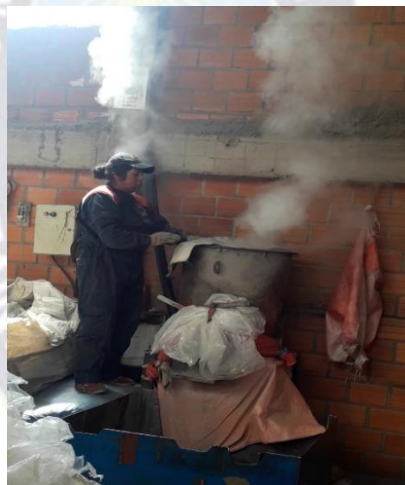
Ilustración 12: Falta de dotación de EPP
