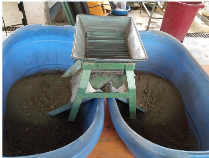
Fotografía 16. Empleo del cuarteador de rifles para distribuir a las diversas etapas del proceso
