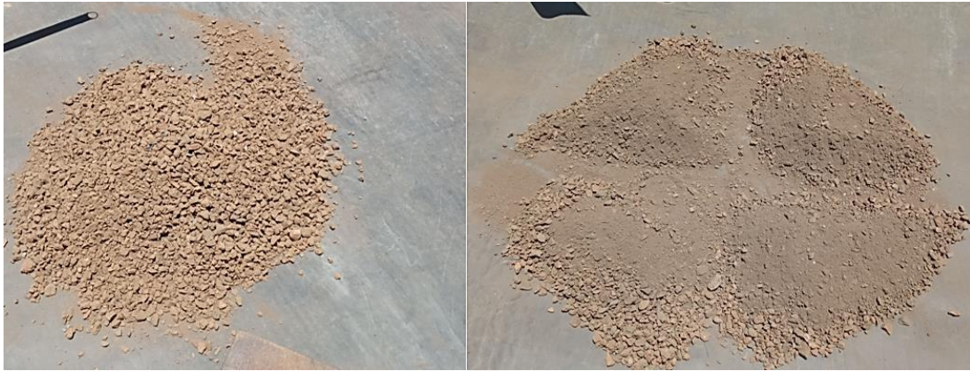
Fotografía 15. Homogenización y cuarteo de la carga por el “método de cono y cuarteo”
