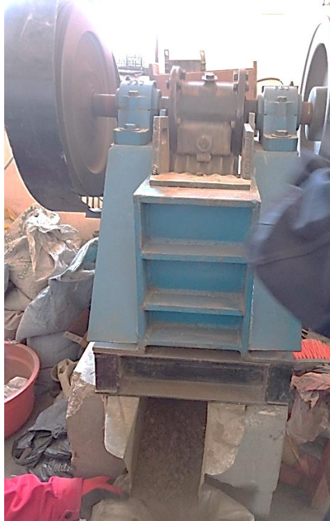
Fotografía 14. Proceso de trituración de la muestra
