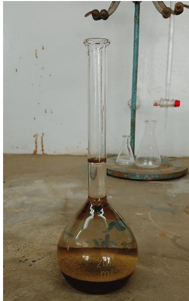
Fotografía 17. Mineral y agua para determinación de peso específico real
