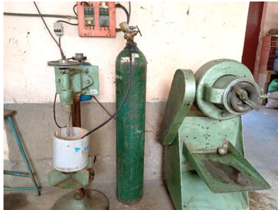
Fotografía 23. Sistema de oxidación empleando oxígeno industrial
