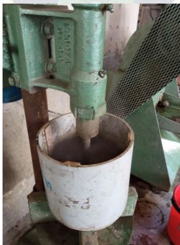
Fotografía 18. Sistema de oxidación con peróxido de hidrógeno
