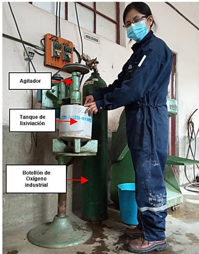
Fotografía 19. Sistema de oxidación con oxígeno industrial y lixiviación en laboratorio
