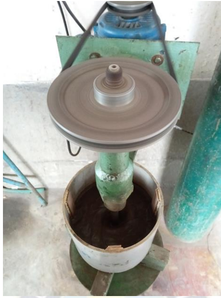
Fotografía 11. Agitador y tanque de lixiviación
