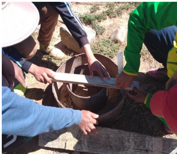
Instalación y prueba de infiltración en el área experimental
