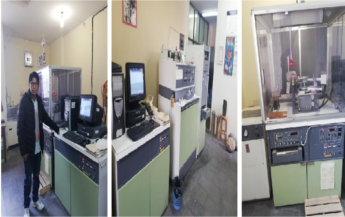
Ilustración 7-7. Caracterización de las muestras por FRX y DRX. Realizado en IGEMA-UMSA
