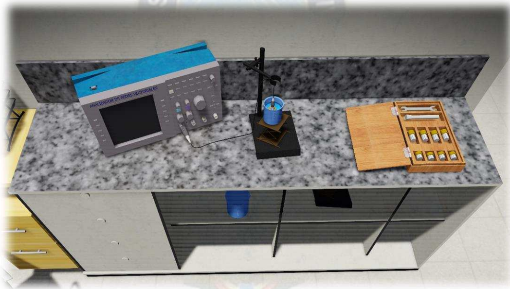
Figura 3.9 Medición de la sonda con agua desionizada y kit de calibración
