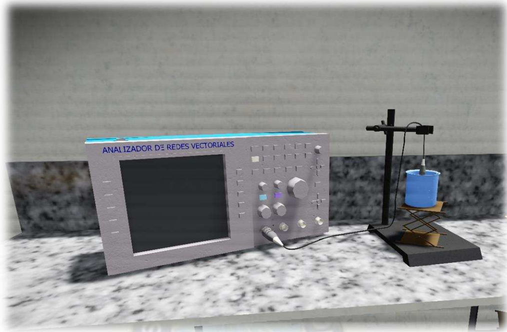
Figura 3.10 Medición de la sonda en el líquido simulador
