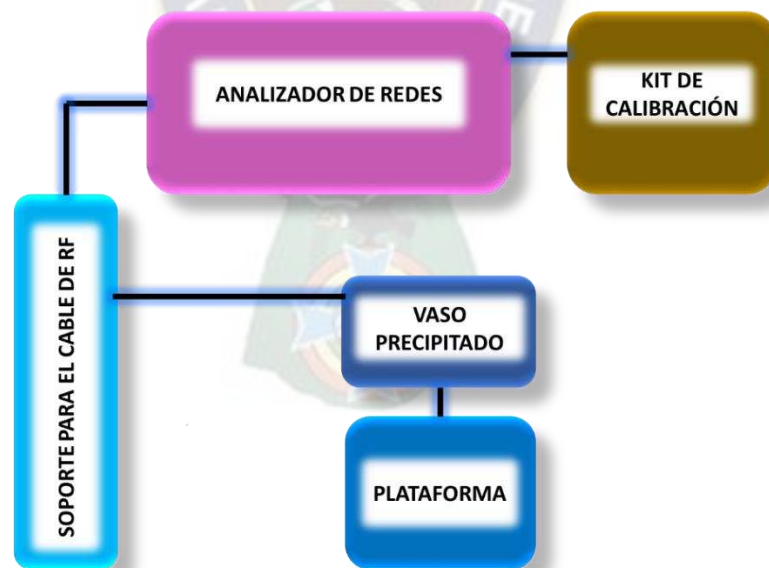
Figura 3.7 Diagrama de conexión para medición del líquido simulador de tejido humano
