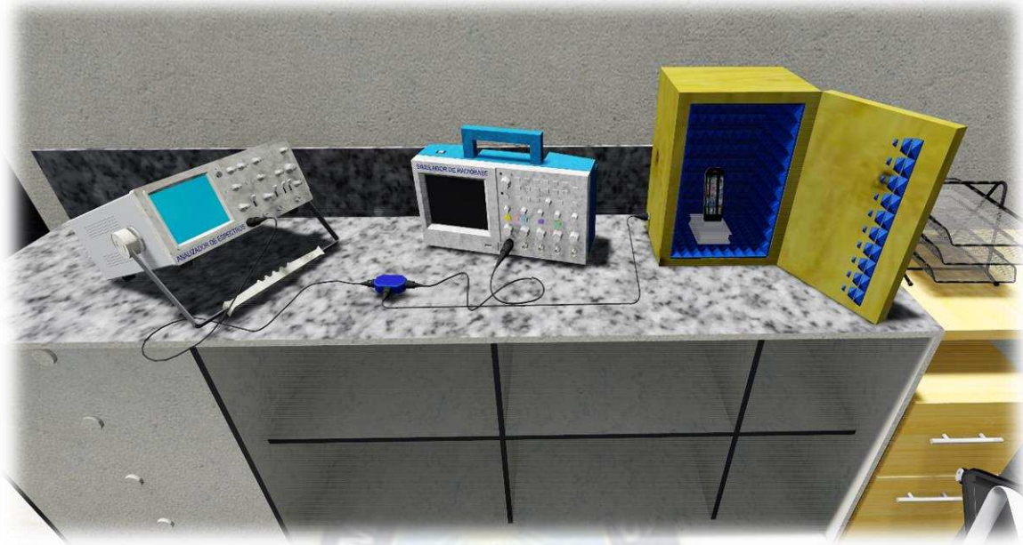
Figura 3.3 Equipos para las pruebas de radiofrecuencia según el 3GPP
