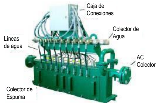
Figura N° 4. Esquema de la maquina patentada de Double Barrel.
