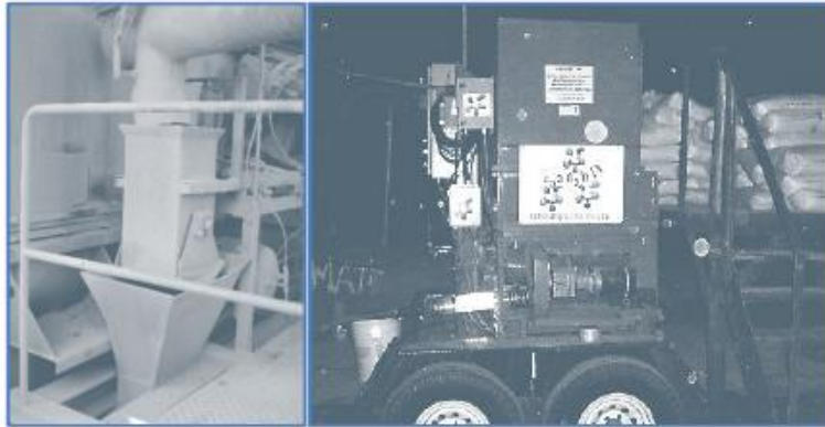
Figura N° 15. Ejemplo de tolva de peso (izquierda) y alimentador neumático (derecha) para introducir aditivos en forma granular o de pastilla
