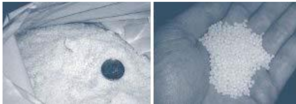
Figura N° 9. Sasobit en forma de polvo y granular.
