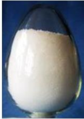
Figura N° 10. Granos de aditivo Rh-WMA.
