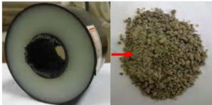
Figura N° 11. El polietileno de reciclado cross-lick, RPPW utilizado como aditivo de WMA [37]
