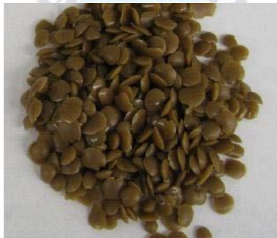
Figura N° 13. Rediset y su forma granular/ pastilla.
