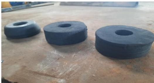
*Fig. 45: Bujes para soporte motor.
