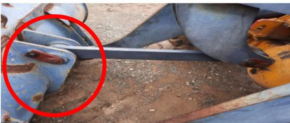
*Fig. 25: Montaje del buje de teflón a la retroexcavadora.*
