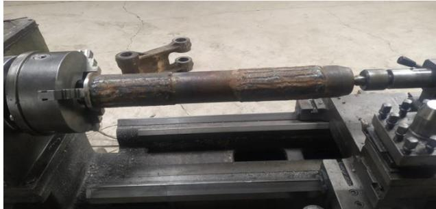
*Fig. 19: Montaje del pasador al torno.*
