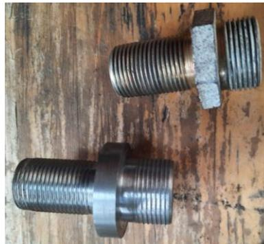
*Fig. 32: Fabricación de niple con rosca.*
