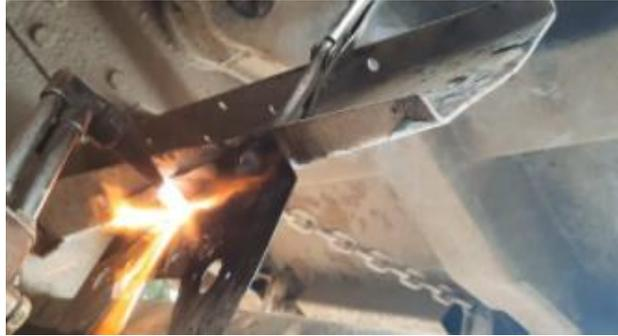
*Fig. 28: Extracción de pernos para reemplazarlos por unos nuevos.*
