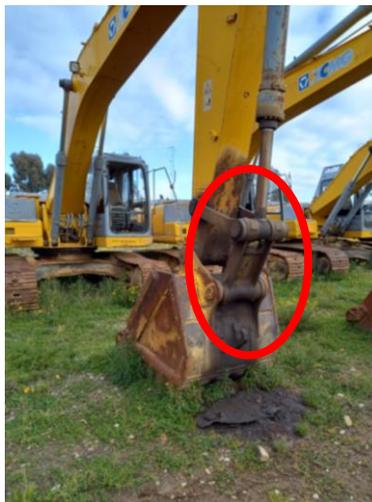
*Fig. 22: Montaje de los pasadores al equipo.*
