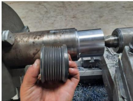
*Fig. 46: Torneado de polea para alternador.*
