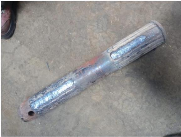
*Fig. 15: Rellenado de pasador con arco eléctrico.*
