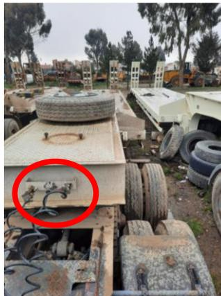
*Fig. 34: Montaje del niple al camión tráiler.*
