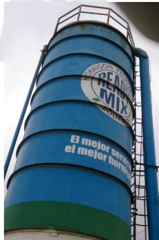
FIGURA 3-1 ALMACENAMIENTO DE CEMENTO
