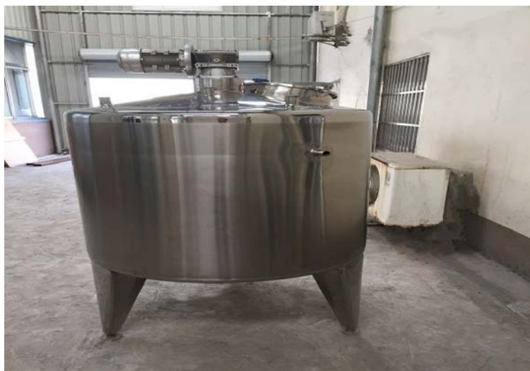
Tanque de mezcla
