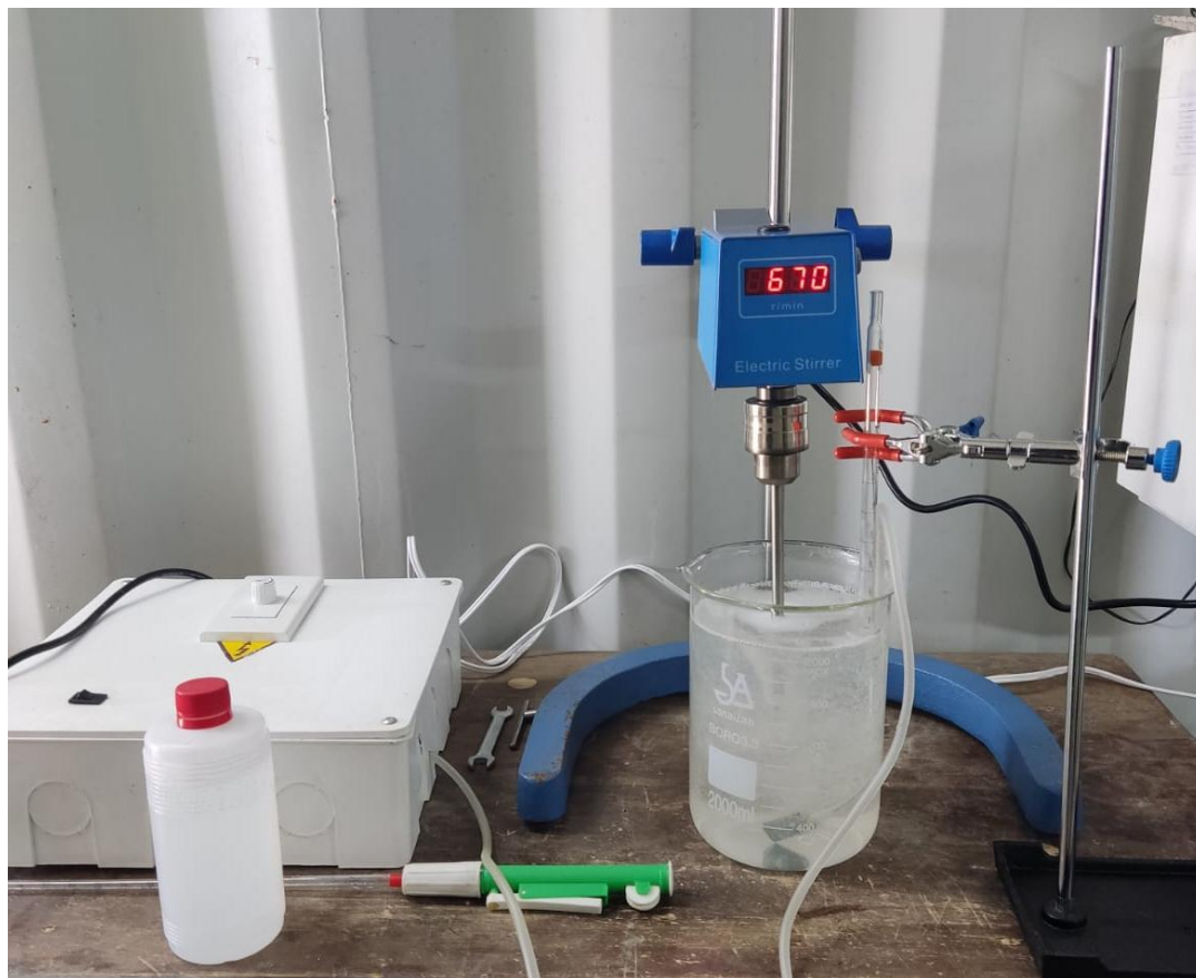
Figura 4: Sistema construido para el tratamiento de aguas residuales
