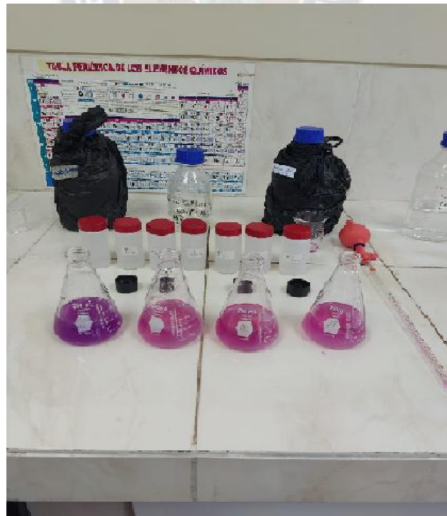
Figura 6: Muestras después de la adición de solución de AgNO_3 , H_2SO_4 y KMnO_4
