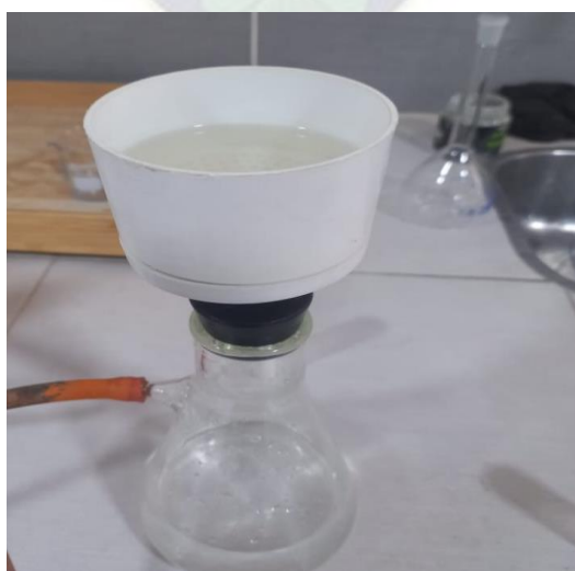
Figura 42. Filtrado de salmuera para análisis de insolubles. Fuente: Elaboración propia
